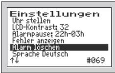
Trat eine Störung (Alarm) auf, so kann diese durch Drücken der
