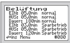
In diesem Menü wird eingestellt, für wie viele Minuten im Normalbetrieb die Belüftung EIN bzw. AUS geschaltet sein soll (Taktung).
