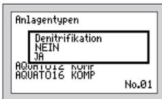
**Denitrifikation:** In der ersten Zeile wird der derzeit eingestellte Zustand angezeigt. In der zweiten Zeile kann der Zustand verändert werden. Durch Drücken der - Tasten wird zwischen JA oder NEIN ausgewählt. Mit der - Taste wird der gewählte Zustand übernommen.
