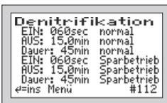
In diesem Menü wird eingestellt, für wie viele Minuten die Belüftung EIN bzw. AUS geschaltet sein soll; jeweils für den Normal- und den Sparbetrieb, allerdings nur für die Denitrifikation.
