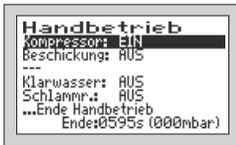
Im Handbetrieb kann jedes der Aggregate manuell EIN oder AUS geschaltet werden (z.B. für einen Testlauf).
