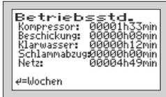
Im Menüpunkt BETRIEBSSTUNDEN werden die Betriebsstunden der jeweiligen Aggregate angezeigt. Die Betriebsstunden werden hochgezählt, wenn die Steuerung den Kompressor bzw. die Pumpe eingeschaltet hat. Die Anzeige erfolgt in Stunden und Minuten.
