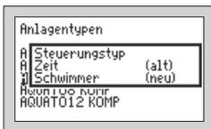
**Steuerungstyp:** In der ersten Zeile wird der derzeit eingestellte Zustand angezeigt. In der zweiten Zeile kann der Zustand verändert werden. Durch Drücken der - Tasten wird zwischen ZEIT oder SCHWIMMER ausgewählt. Mit der - Taste wird der gewählte Zustand übernommen. Bei Einstellung ZEIT ist der Ablauf zeitgesteuert, bei SCHWIMMER ist er schwimmergesteuert.
