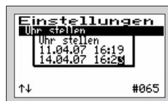
Beispiel: Änderung des Datums vom 11.04.07 auf den 14.04.07 und der Zeit von 16:19 auf 16:23 Uhr. Die Uhr arbeitet quartzgesteuert. Sie sollte bei der Wartung mit geprüft werden.
