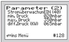
Wenn die Steuerung den Verdichter bzw. eine Pumpe einschaltet, so ist nicht zweifelsfrei sichergestellt, dass diese(r) auch läuft.
