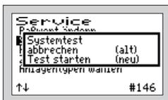
Der automatische Testbetrieb wird über das Auswahlmüenü TEST STARTEN ausgewählt. Im Testbetrieb wird überprüft, ob die Aggregate ordnungsgemäß Strom aufnehmen.
