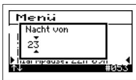
In dem Menü kann der Zeitraum angegeben werden in dem kein akustischer Alarm ertönen soll. Nach der Betätigung der mittleren Taste erscheint die Einstellung der Anfangsstunde, die durch die Pfeiltasten verstellt werden kann, und als zweites Menü erscheint die Einstellung der Endstunden.
