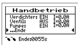
Im Handbetrieb kann jedes der Aggregate manuell EIN oder AUS geschaltet werden (z.B. für eine genaue Fehleranalyse). Zusätzlich kann die Stromaufnahme der eingeschalteten Aggregate abgelesen werden. Mit
