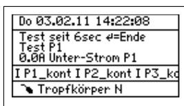
Während des Testbetriebes ändert sich die Hauptanzeige und alle Aggregate werden angesteuert, um die ordnungsgemäße Stromaufnahme zu prüfen. Durch Anheben des Schwimmerschalters ist auch dieser Aggregatzustand prüfbar und im Display sichtbar.
