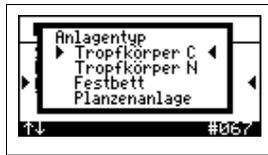
In diesem Menü kann der Anlagentyp eingestellt werden. Wählen Sie den Menüpunkt ANLAGENTYPEN WÄHLEN aus und drücken dann die mittlere Taste. Mit den Pfeil Tasten wählen Sie den passenden Anlagentyp. (siehe Kapitel 3.2)
