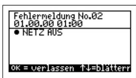
Über dieses Menü wird das Fehlerlogbuch aufgerufen. Das Fehlerlogbuch zeigt die letzten 20 Fehlerereignisse mit Datum und Uhrzeit an. Mit den Pfeiltasten wird im Logbuch geblättert, mit der mittleren Taste wird das Menü verlassen. (Im Fehlerlogbuch kann nichts gelöscht werden!)
