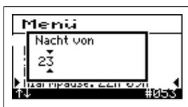
In dem Menü kann der Zeitraum angegeben werden, in dem kein akustischer Alarm ertönen soll. Nach der Betätigung der mittleren Taste erscheint die Einstellung der Anfangsstunde, die durch die Pfeiltasten verstellt werden kann, und als zweites Menü erscheinen die Endstunden.
