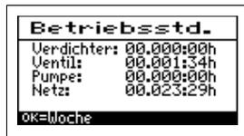
In diesem Menüpunkt werden die Betriebsstunden der jeweiligen Aggregate angezeigt. Die Betriebsstunden werden hochgezählt, wenn die Steuerung den Verdichter, Ventil bzw. die Pumpe eingeschaltet hat. Die Anzeige erfolgt in Stunden und Minuten.
