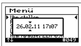
Durch die Betätigung der mittleren Taste erscheint das folgende Menü, in dem dann Tag, Monat, Jahr, Stunden und Minuten eingestellt werden können. Durch die Pfeil-Tasten sind die einzelnen Werte zu verstellen und mit mittleren Taste springen Sie in den nächsten Einstellungsbereich.
