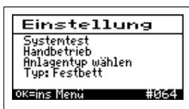
Das Einstellmenü ist im Wesentlichen für den Servicetechniker bestimmt. In diesem Menü wird das System getestet, der Handbetrieb eingeschaltet sowie der Anlagentyp (Funktionsweise der Kläranlage) eingegeben.
