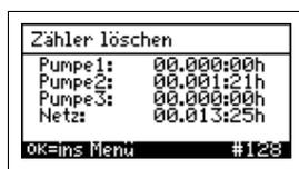
In dem Menü können die Betriebsstundenzähler gelöscht werden. Das Einstellmenü ist für den Servicetechniker bestimmt. Für diese Menüpunkte benötigen Sie das Passwort.
