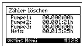
In dem Menü können die Betriebsstundenzähler gelöscht werden. Das Einstellmenü ist für den Servicetechniker bestimmt.
