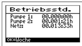
In diesem Menüpunkt werden die Betriebsstunden der jeweiligen Aggregate angezeigt. Die Betriebsstunden werden hochgezählt, wenn die Steuerung die Pumpe 1 bzw. die Pumpe 2 eingeschaltet hat. Die Anzeige erfolgt in Stunden und Minuten.
