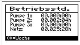
In diesem Menüpunkt werden die Betriebsstunden der jeweiligen Aggregate angezeigt. Die Betriebsstunden werden hochgezählt, wenn die Steuerung den Belüfter bzw. die Pumpe eingeschaltet hat. Die Anzeige erfolgt in Stunden und Minuten.
