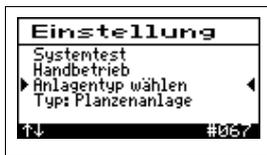
Das Einstellmenü ist im Wesentlichen für den Servicetechniker bestimmt. In diesem Menü wird das System getestet der Handbetrieb eingeschaltet sowie der Anlagentyp (Funktionsweise der Kläranlage) eingegeben. Für diese Menüpunkte benötigen Sie das Passwort.
