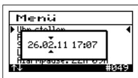
Durch die Betätigung der mittleren Taste erscheint das folgende Menü in dem dann Tag, Monat, Jahr, Stunden und Minuten eingestellt werden können. Durch die Pfeiltasten sind die einzelnen Werte zu verstellen und mit der mittleren Taste springen Sie in den nächsten Einstellungsbereich.
