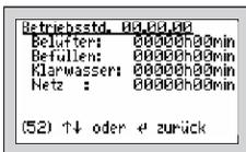
Im Menü „BETRIEBSSTUNDEN“ werden die Betriebsstunden der jeweiligen Aggregate angezeigt. Die Betriebsstunden werden hochgezählt, wenn die Steuerung den Kompressor (bzw. eventuell eine Pumpe) eingeschaltet hat. Die Anzeige erfolgt in Stunden und Minuten.
