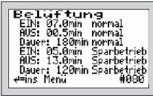
Im Menü „BELÜFTUNG“ werden die ausgewählten Belüftungsintervalle im Normalbetrieb angezeigt, d. h. für wie viele Minuten die Belüftung jeweils im Wechsel „EIN“ bzw. „AUS“ geschaltet wird (Taktung). Darunter wird die Gesamtdauer der Belüftung („DAUER:“) angezeigt.
