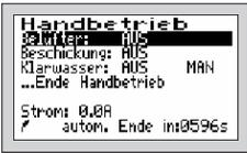
Im Handbetrieb der Steuerung K-Pilot 8.3 kann jedes der Aggregate manuell „EIN“ oder „AUS“ geschaltet werden. Zusätzlich kann die Stromaufnahme der „EIN“ geschalteten Aggregate abgelesen werden.
