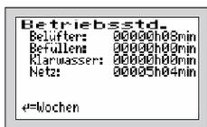
Im Kapitel BETRIEBSSTUNDEN Ihrer Steuerung werden die Betriebsstunden der jeweiligen Aggregate angezeigt. Die Betriebsstunden werden hochgezählt, wenn die Steuerung die Tauchmotorpumpe bzw. den Tauchmotorbelüfter eingeschaltet hat. Die Anzeige erfolgt in Stunden und Minuten.
