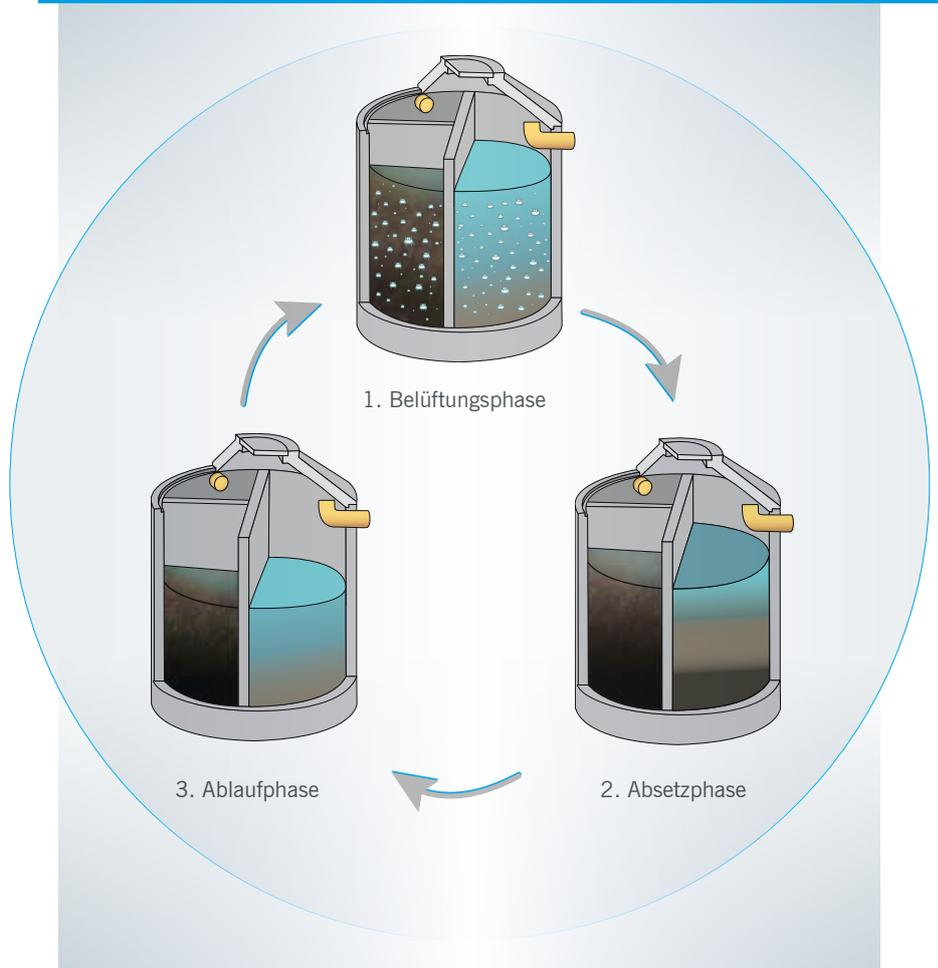
Alle Vorgänge in der Anlage erfolgen nach einem regelmäßigen Zyklus, der von der Steuerung vorgegeben wird.
