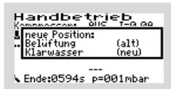
Mit den -Tasten wird die gewünschte Ventilposition ausgewählt und nach Betätigen der -Taste wird diese Position angefahren. Ist dabei der Kompressor auf „EIN“ geschaltet, kann die Funktion zusätzlich auch im Behälter geprüft werden.
