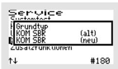
Als erstes wird nach dem „GRUNDTYP“ der Anlage gefragt: „KOM SBR“ oder „STABI SSB“. Mit den -Tasten wählen Sie den gewünschten Typ in der zweiten Zeile „(NEU)“ aus. Für den Betrieb als SBR-Anlage wählen Sie „KOM SBR“ und bestätigen Sie mit .
