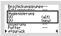
Nach dem Beenden des Menüs kommt in diesem Fall noch die Abfrage, welche „HYGIENISIERUNG“ gewünscht ist. Zum Betrieb der UV-Lampe wählen Sie „UV“.
