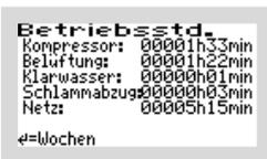
Im Menü „BETRIEBSSTUNDEN“ werden die Betriebsstunden der jeweiligen Aggregate angezeigt. Die Betriebsstunden werden hochgezählt, wenn die Steuerung den Kompressor (bzw. bei Steuerung K-Pilot 18.3/18.4 eventuell eine Pumpe) eingeschaltet hat. Die Anzeige erfolgt in Stunden und Minuten.
