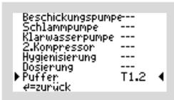
Wurde, wie im Beispiel, zum Betrieb eines Puffers mit Pufferpumpe die Funktion „PUFFER“ auf den Ausgang „T1.2“ gelegt, muss auch der elektrische Anschluss der Pufferpumpe auf diesen Kontakt gelegt werden.
