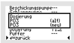
Im Beispiel ist die Dosierpumpe auf den Ausgang T1.2 gelegt, daher muss dieser Ausgang auch in der Software ausgewählt werden.
