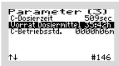
Im Beispiel ist ein Dosiermittelvorrat mit einer Gesamtlaufzeit der Dosierpumpe von 35 Stunden und 42 Minuten eingestellt.
