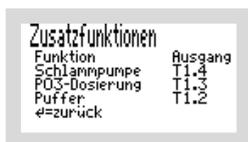
In diesem Beispiel der Anzeige der „ZUSATZFUNKTIONEN“ ist die gewählte Einstellung „SCHLAMPUMPE“ auf dem Ausgang „T1.4“ und „PO3-DOSIERUNG“ zur Fällmitteldosierung für die Phosphatfällung auf „T1.3“ sowie „PUFFER“ auf „T1.2“ für die Pufferpumpe.
