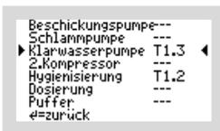
Wurde, wie im Beispiel, die Funktion „HYGIENISIERUNG“ auf den Ausgang „T1.2“ gelegt, muss auch der elektrische Anschluss der Hygienisierung (hier mit UV-Lampe) auf den Kontakt T1.2 gelegt sein. Ebenso wurde im Beispiel die Funktion „KLARWASSERPUMPE“ auf den Ausgang „T1.3“ gelegt, also muss auch der elektrische Anschluss der Klarwasserpumpe auf den Kontakt T1.3 gelegt sein.
