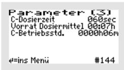
Im Menü Parameter 3 werden die „C-DOSIERZEIT“ pro Zyklus, der „VORRAT DOSIERMITTEL“ und die Gesamtlaufzeit der Dosierpumpe als „C-BETRIEBSSTD.“ angezeigt. Hier können auch die Einstellungen von „C-DOSIERZEIT“ pro Zyklus und „VORRAT DOSIERMITTEL“ geändert werden.
