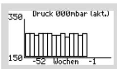
Im Grafik-Menü „DRUCK“ wird in der oberen Zeile der aktuelle Druck sowie in der Grafik wöchentlich der Gegendruck (aus der Drucküberwachung) dokumentiert.
