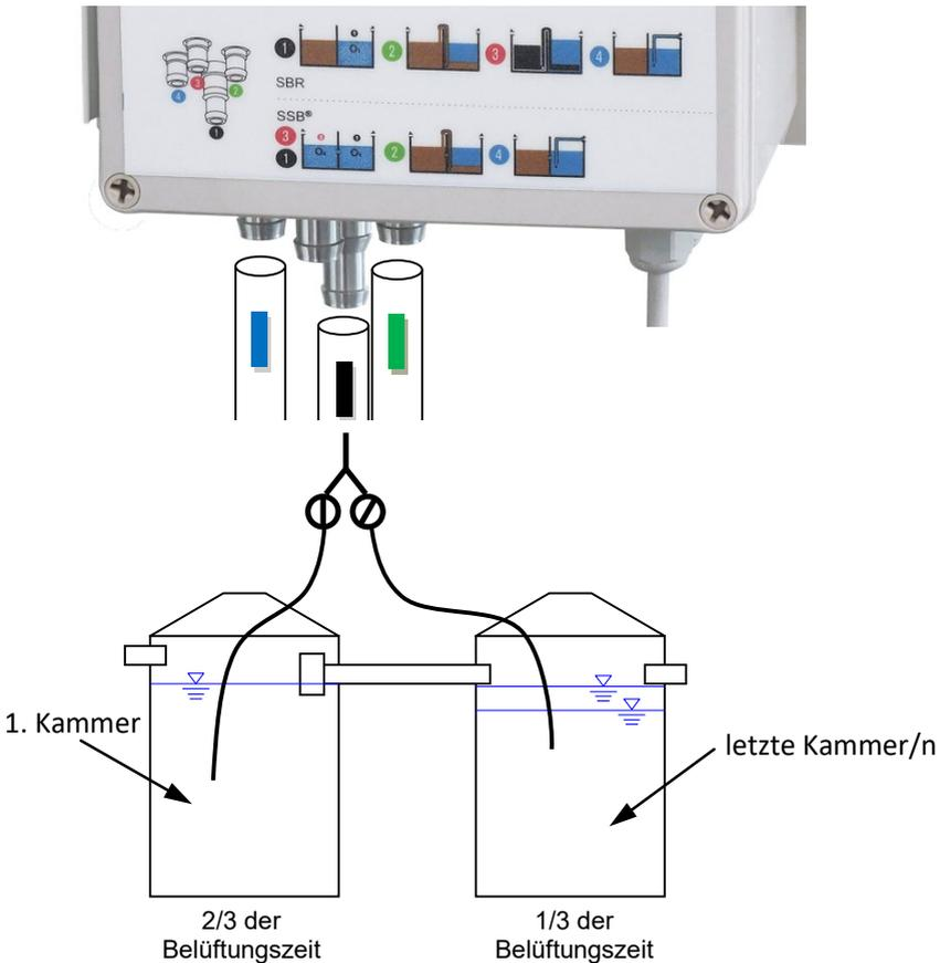
**Abbildung 6:** Schlauchanschlüsse – Belegung bei SSB-Sondervariante
