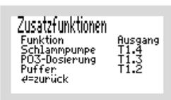
In diesem Beispiel der Anzeige der „ZUSATZFUNKTIONEN“ ist die gewählte Einstellung „SCHLAMMPUMPE“ auf dem Ausgang „T1.4“ und „PO3-DOSIERUNG“ zur Fällmitteldosierung für die Phosphatfällung auf „T1.3“ sowie „PUFFER“ auf „T1.2“ für die Pufferpumpe.
