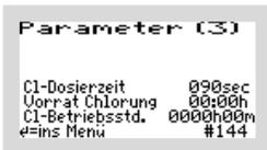
Im Menü Parameter 3 werden die „CL-DOSIERZEIT“ pro Zyklus, der „VORRAT CHLORUNG“ und die Gesamtlaufzeit der Dosierpumpe als „CL-BETRIEBSSTD.“ angezeigt. Hier können auch die Einstellungen von „CL-DOSIERZEIT“ pro Zyklus und „VORRAT CHLORUNG“ geändert werden.
