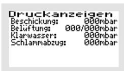
In diesem Menü wird der jeweilige Druck während des letzten Zyklus angezeigt. Beschickungs-, Klarwasser- und Überschusschlammgegendruck werden jeweils bei den einzelnen Vorgängen gespeichert. Es wird immer nur die Druckmessung der jeweiligen letzten Phase angezeigt.
