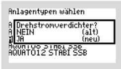
Schalten Sie die Überwachung im Menü „3~FEHLER ÜBERW.“ mit „JA“ ein, gibt es bei Ausfall des Gerätes eine Fehlermeldung. **Für diese Überwachung muss die Steuerung allerdings ab Werk vorbereitet werden.** Wurde die Steuerung nicht vorbereitet, ist „NEIN“ zu wählen.
