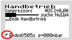
Dann wird die gewählte Position angefahren. Dies zeigt der Laufbalken im Menü an.
