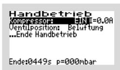
Im Handbetrieb kann der KOMPRESSOR manuell „EIN“ oder „AUS“ geschaltet sowie jede verfügbare VENTILPOSITION angefahren werden (z. B. für einen Testlauf).
