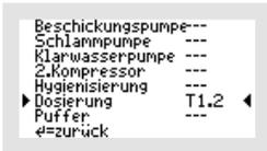
Danach wird mit der -Taste der elektrische Ausgang ausgewählt, der genutzt werden soll. Bei jedem Tastendruck der -Taste wechselt die Anzeige in der markierten Zeile. Von „- -“ wechselt sie auf die Ausgänge von T1.2 über T1.3 zu T1.4 und wieder zurück zu „- -“.
