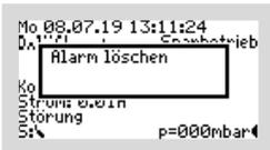
Dadurch wird der Summer abgeschaltet und es öffnet sich das Fenster „ALARM LÖSCHEN“. Direkt danach folgt die Abfrage „SICHER?“
