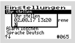
Die erste Ziffer kann mit den -Tasten geändert werden. Ist der richtige Wert eingestellt, wird mit der mittleren -Taste die Ziffer übernommen. Auf die gleiche Art geht es mit allen folgenden Ziffern weiter.
