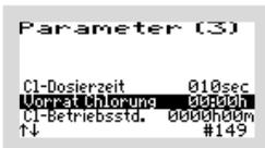
Um einzustellen wie lange der Fällmittelvorrat ausreicht, wird mit den -Tasten die Zeile „VORRAT CHLORUNG“ ausgewählt.
