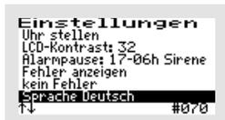
Hier wird die Sprache der Steuerung ausgewählt. Die Eingabe des Passwortes ist dafür nötig. Die Steuerung ist vorbereitet für mehrere Sprachen. Zurzeit programmierte Sprachen sind:
