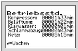
Im Kapitel BETRIEBSSTUNDEN Ihrer Steuerung werden die Betriebsstunden der jeweiligen Aggregate angezeigt. Die Betriebsstunden werden hochgezählt, wenn die Steuerung den Kompressor (bzw. bei Steuerung K-Pilot 18.3 eventuell die Pumpe) eingeschaltet hat. Die Anzeige erfolgt in Stunden und Minuten.
