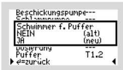
Nach dem Beenden des Menüs kommt in diesem Fall noch die Abfrage, ob die Pufferentleerung mit einem Schwimmerschalter gesteuert werden soll: „SCHWIMMER F. PUFFER“. Soll der Puffer schwimmergesteuert entleert werden, wählen Sie „JA“. Diese Option darf **nur** bei der Steuerung **K-Pilot 18.3** gewählt werden. Soll der Puffer rein zeitgesteuert entleert werden, wählen Sie „NEIN“.
