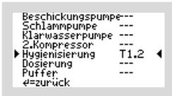
Wurde, wie im Beispiel, die Funktion „HYGIENISIERUNG“ auf den Ausgang „T1.2“ gelegt, muss auch der elektrische Anschluss der Hygienisierung (hier mit Desinfektionsmitteldosierung) auf diesen Kontakt gelegt werden.
