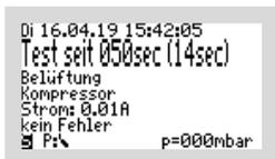
Während des Testbetriebs – dieser dauert ca. 100 Sekunden – ändert sich die Hauptanzeige der Zeile 2 in: „Test seit XX sec“. Der Systemtest prüft die einzelnen Funktionen nacheinander und testet, ob sie richtig arbeiten. Funktioniert alles fehlerfrei, kommt keine Alarmmeldung.
