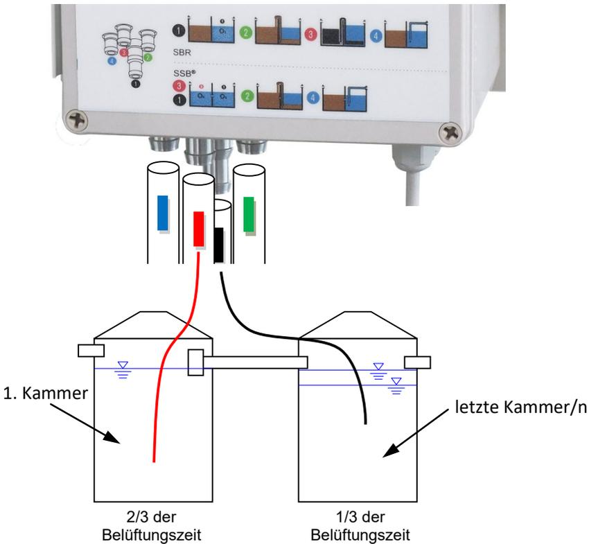
**Abbildung 5:** Schlauchanschlüsse – Belegung bei SSB-Standardvariante
