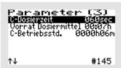
Mit der (mittleren) -Taste kommen Sie ins Menü. Die Zeile „C-DOSIERZEIT“ wird mit den -Tasten ausgewählt.
