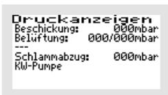
Ist statt des betreffenden Hebers eine Beschickungs-, Schlamm- und/oder Klarwasserpumpe angeschlossen, wird dies unterhalb der eigentlichen Druckanzeigen als Text angezeigt. Zudem wird dieser Ausgang nicht als Druckausgang angezeigt.
