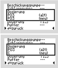
Nach dem Beenden des Menüs kommt in diesem Fall noch die Abfrage, welche „DOSIERUNG“ gewünscht/erforderlich ist. Soll eine Phosphatfällung betrieben werden, wählen Sie „PO3“, soll eine C-Quelle zudosiert werden, wählen Sie „C“.
