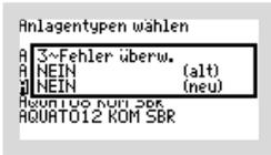
Haben Sie bei der Abfrage „DREHSTROMVERDICHTER?“ „JA“ gewählt, folgt die Abfrage ob der Drehstromverdichter auf Stromfehler überwacht werden soll.
