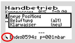
Wurde der Steuerungstyp „SCHWIMMER“ (bei der Inbetriebnahme) gewählt, ist links unten das Schwimmerschalter-Symbol mit der aktuellen Schwimmerstellung sichtbar.
