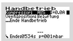
Ist der Kompressor ausgewählt, kann er mit der -Taste „EIN“ bzw. „AUS“ geschaltet werden.
