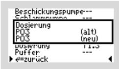
Nach dem Beenden des Menüs kommt in diesem Fall noch die Abfrage, welche „DOSIERUNG“ gewünscht/erforderlich ist. Soll eine Phosphatfällung betrieben werden, wählen Sie „PO3“, soll eine C-Quelle zudosiert werden, wählen Sie „C“.
