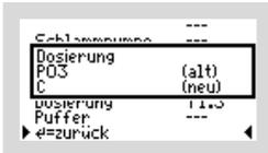
Nur wenn, wie im Beispiel, bei der Funktion „DOSIERUNG“ eine „C“-Quelle gewählt wurde, folgt danach noch die Abfrage, wie häufig die C-Quelle zudosiert werden soll. Die Dosierung der „C“-Quelle erfolgt ausschließlich im Sparbetrieb, wenn der Biologie keine anderen Nährstoffe zugeführt werden.
