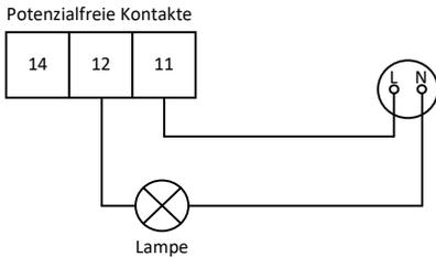
**Abbildung 10:** Potenzialfreier Kontakt mit Fehlermeldung – Stromversorgung aus der Steuerung
