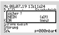
Bei der Auswahl von „JA“ wird auch die Fehleranzeige im Display gelöscht.
