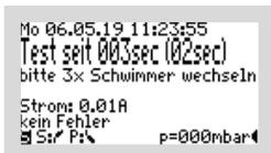
Ist der STEUERUNGSTYP „SCHWIMMER“ eingestellt, muss zu Beginn des Systemtests 3 mal der Schwimmerschalter auf und ab bewegt werden, um die Funktion des Schwimmerschalters zu überprüfen. Danach läuft der Test vollautomatisch ab. Bei STEUERUNGSTYP „ZEIT“ entfällt die Schwimmerprüfung, es beginnt direkt der vollautomatische Testbetrieb.
