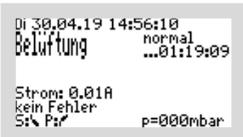
1. Zeile: Datum und Uhrzeit sowie, wenn die Einstellung „Belüftung 1. Kammer“ „JA“ gewählt wurde, hinter der Uhrzeit das Sternchensymbol „\*“ als Anzeige für diese Einstellung
