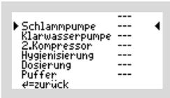
Um ein Aggregat aktivieren zu können, muss die Zeile mit der gewünschten/erforderlichen Zusatzfunktion mit den -Tasten ausgewählt werden. Danach wird mit der -Taste, der elektrische Ausgang ausgewählt, der genutzt werden soll. Bei jedem Tastendruck der -Taste wechselt die Anzeige in der markierten Zeile. Von „- -“ wechselt sie auf die Ausgänge von T1.2 über T1.3 zu T1.4 und wieder zurück zu „- -“.
