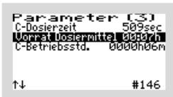
Um einzustellen wie lange der Fällmittelvorrat ausreicht, wird mit den -Tasten die Zeile „VORRAT DOSIERMITTEL“ ausgewählt.
