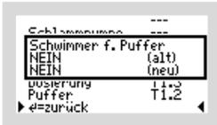
Bei der Steuerung **K-Pilot 18.4** muss die Option „**NEIN**“ gewählt werden, da kein Anschluss für den Pufferschwimmer vorhanden ist. Der Puffer kann nur rein zeitgesteuert entleert werden.
