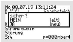
Bei der Auswahl von „JA“ wird auch die Fehleranzeige im Display gelöscht.
