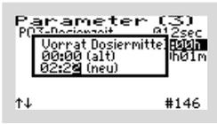
Dabei wird nicht direkt die gespeicherte Menge des Dosiermittels eingegeben, sondern die Dosierpumpengesamtlaufzeit, für die der Vorrat reicht. (Berechnung siehe unten)
