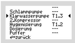
Wurde, wie im Beispiel, die Funktion „**HYGIENISIERUNG**“ auf den Ausgang „T1.2“ gelegt, muss auch der elektrische Anschluss der Hygienisierung (UV-Lampe oder Desinfektionsmitteldosierung) auf diesen Kontakt gelegt werden.
