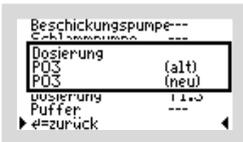
Bei Auswahl von „PO3“ wird das Fällmittel im Normalbetrieb jeweils einmal pro Zyklus zudosiert. Im Sparbetrieb entfällt die Dosierung, da der Anlage in dieser Zeit kein neues Phosphat zugeführt wird.
