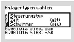
Für den Betrieb einer Anlage mit UV-Lampe oder Dosierung muss der STEUERUNGSTYP „SCHWIMMER“ ausgewählt werden.
