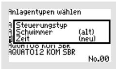
Mit dem Fenster „STEUERUNGSTYP“ können Sie zwischen einem zeit- oder einem schwimmergesteuerten Zyklus auswählen. In der zweiten Zeile „(NEU)“ kann der gewünschte Steuerungstyp eingestellt werden. Durch Betätigen der -Tasten wird zwischen „ZEIT“ oder „SCHWIMMER“ ausgewählt. Mit der -Taste wird der gewählte Steuerungstyp übernommen. Mit der Einstellung „ZEIT“ wird der Ablauf des Zyklus nur über die Zeit gesteuert, mit der Einstellung „SCHWIMMER“ ist er zusätzlich schwimmergesteuert.
