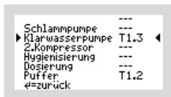
Bei der Steuerung **K-Pilot 18.3** stehen die Ausgänge „T1.2“ und „T1.3“ zur Verfügung. Es können also maximal 2 Zusatzfunktionen ausgewählt werden, wie hier im Beispiel Puffer- und Klarwasserpumpe.
