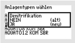
Ist eine „DENITRIFIKATION“ gewünscht/erforderlich, kann diese im nächsten Fenster zugeschaltet werden. In der zweiten Zeile „(NEU)“ kann die gewünschte Option ausgewählt werden. Die Auswahl zwischen „JA“ oder „NEIN“ erfolgt mit den -Tasten. Mit der -Taste wird der gewählte Zustand übernommen. „JA“ bedeutet, die Anlage läuft mit Denitrifikationsphase, bei „NEIN“ ist diese Phase abgeschaltet.
