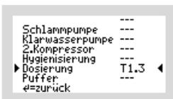
Wurde, wie im Beispiel, die Funktion „**DOSIERUNG**“ auf den Ausgang „T1.3“ gelegt, muss auch der elektrische Anschluss der Dosierpumpe auf diesen Kontakt gelegt werden.
