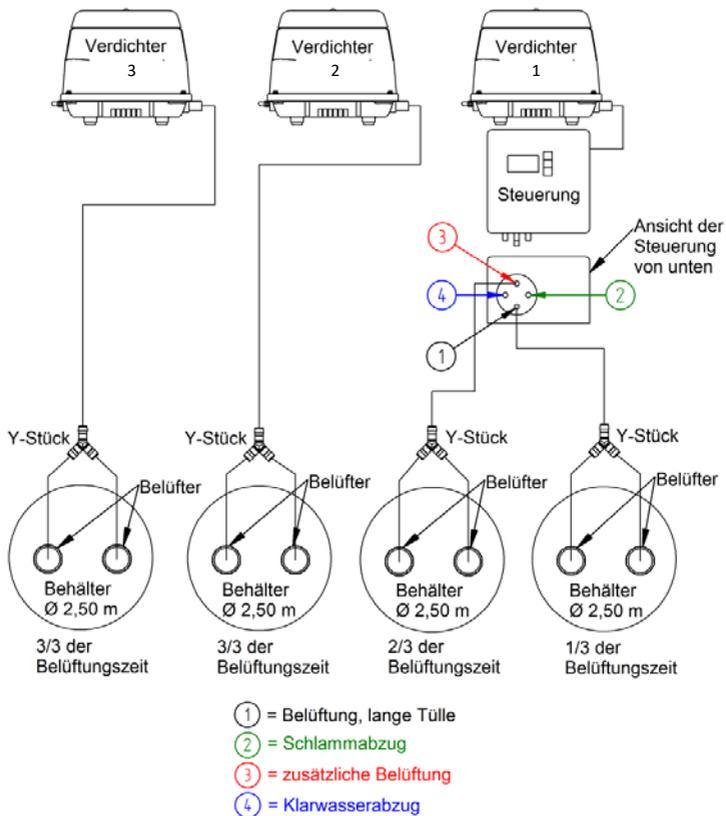
**Abbildung 8:** Schlauchanschlüsse – Belegung bei SSB-3-Verdichter-Anlage (4 Behälter)
