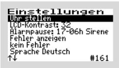
Um die Uhrzeit und/oder das Datum zu korrigieren, wählen Sie mit den -Tasten die Zeile „UHR STELLEN“ aus. Ist die Markierung (=schwarzer Balken) auf dem gewünschten Eintrag, wird mit der mittleren -Taste das Fenster zum Anpassen der Werte geöffnet.
