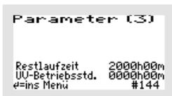
Im Menü Parameter 3 werden die „RESTLAUFZEIT“ der UV-Lampe und die Gesamtlaufzeit der UV-Leuchte als „UV-BETRIEBSSTD.“ angezeigt. Hier wird die Einstellungen von „RESTLAUFZEIT“ nach dem Leuchtenwechsel wieder auf 2000 Stunden eingestellt.
