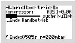
Nach Auswahl der gewünschten Ventilposition wird von der Steuerung zunächst der Nullpunkt gesucht.
