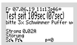
Ist die Option PUFFER MIT SCHWIMMER eingestellt, muss am Ende des Systemtests 3 mal der Schwimmerschalter für den Puffer auf und ab bewegt werden, um die Funktion des Schwimmerschalters zu überprüfen. Danach endet der Testbetrieb.
