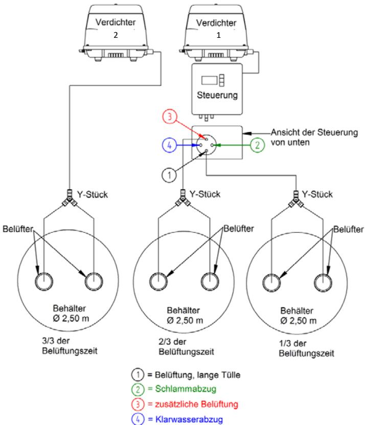
Abbildung 7: Schlauchanschlüsse – Belegung bei SSB-2-Verdichter-Anlage (3 Behälter)
