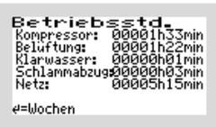
Im Menü BETRIEBSSTUNDEN werden die Betriebsstunden der jeweiligen Aggregate angezeigt. Die Betriebsstunden werden hochgezählt, wenn die Steuerung den Kompressor (bzw. bei Steuerung K-Pilot 18.3 eventuell die Pumpe) eingeschaltet hat. Die Anzeige erfolgt in Stunden und Minuten.
