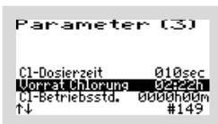
Im Beispiel ist ein Dosiermittelvorrat (= „VORRAT CHLORUNG“) mit einer Gesamtlaufzeit der Dosierpumpe von 2 Stunden und 22 Minuten eingestellt.
