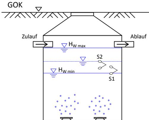
**Abbildung 33: Anlage mit Doppelschwimmerschalter**
