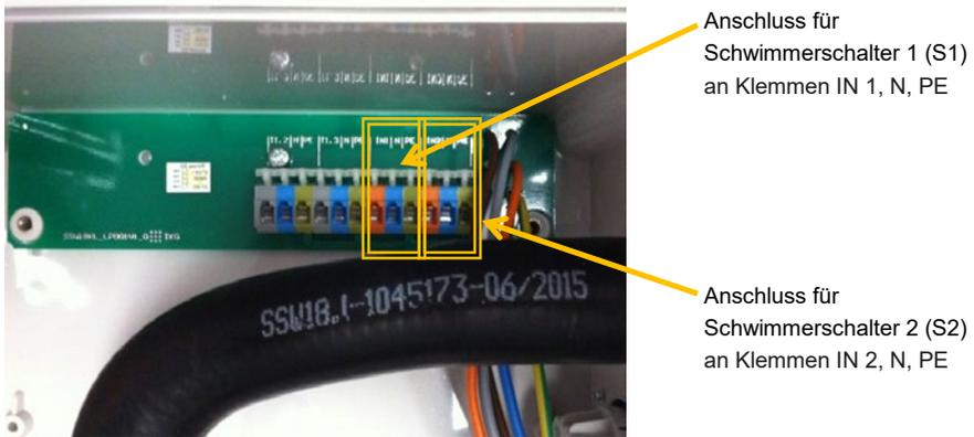
**Abbildung 18:** Anschluss Doppel-Schwimmerschalter bei Steuerung K-Pilot 18.3
