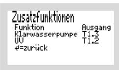
Hier als Beispiel die Anzeige der „ZUSATZFUNKTIONEN“ mit der gewählten Einstellung „Klarwasserpumpe“ auf dem Ausgang „T1.3“ und „UV“ für die UV-Lampe „T1.2“.
