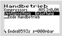
Ist die „VENTILPOSITION“ ausgewählt, wird mit der
