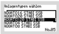
Für die Anlagengrößen von 21 bis 50 EW treffen Sie bitte die Auswahl „AQUATO>20 STABI SSB“. Die Zyklus-Voreinstellungen für die Anlagengrößen von 21 bis 50 EW sind gleich, die unterschiedlichen benötigten Luftmengen werden durch unterschiedliche Größen und Mengen von Membranbelüftern und Verdichtern erreicht. Bei Bedarf können diese Einstellungen nachreguliert werden.
