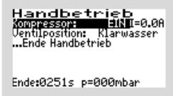
Nach Erreichen der Position wird bei eingeschaltetem Verdichter auch die Funktion, hier zum Beispiel der Klarwasserabzug, wie im Automatikbetrieb ausgeführt und kann zusätzlich auch im Behälter überprüft werden.
