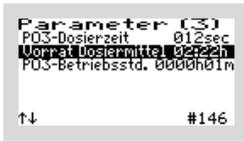
Im Beispiel ist ein Dosiermittelvorrat mit einer Gesamtlaufzeit der Dosierpumpe von 2 Stunden und 22 Minuten eingestellt.
