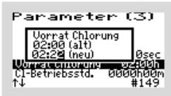
Dabei wird nicht direkt die gespeicherte Menge des Dosiermittels eingegeben, sondern die Dosierpumpengesamtlaufzeit, für die der Vorrat reicht. (Berechnung siehe unten)
