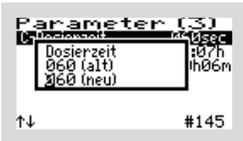
Im Beispiel wird eine Änderung der C-Dosierzeit von 60 auf 509 Sekunden pro Dosierung eingestellt.
