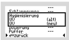
Nach dem Beenden des Menüs kommt in diesem Fall noch die Abfrage, welche „**HYGIENISIERUNG**“ gewünscht ist. Soll eine UV-Lampe betrieben werden, wählen Sie „UV“, soll ein Desinfektionsmittel, wie z. B. Chlor zudosiert werden, wählen Sie „Cl“.
