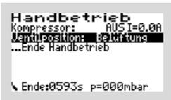
Ist die „VENTILPOSITION“ ausgewählt, wird mit der
