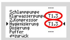
Jeder ausgewählten Funktion muss ein anderer Ausgang zugewiesen werden. Es darf **kein Ausgang mit 2 Funktionen** belegt werden! Wird ein Ausgang doppelt ausgewählt, ertönt beim Verlassen des Untermenüs ein Warnton und die Zeilenmarkierung springt – ohne das Menü zu verlassen – in die oberste Zeile zurück, sodass die Auswahl in den betreffenden Zeilen korrigiert werden kann.
