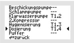
Bei der Steuerung **K-Pilot 18.4** stehen die Ausgänge „T1.2“, „T1.3“ und „T1.4“ zur Verfügung. Es können also maximal 3 Zusatzfunktionen ausgewählt werden, wie hier im Beispiel Klarwasserpumpe, Hygienisierung und Dosierung.
