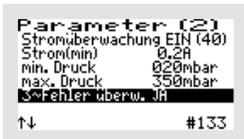
Ist ein Drehstrom-/Drei-Phasen-Verdichter ausgewählt, kann für diesen die Stromüberwachung separat „EIN oder „AUS“ geschaltet werden. **Für diese Überwachung muss die Steuerung allerdings ab Werk vorbereitet werden.** Wurde die Steuerung nicht vorbereitet, ist
