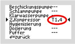
Der Ausgang „T1.4“ darf bei der Steuerung **K-Pilot 18.3** **nicht** belegt werden, da er physisch nicht zur Verfügung steht! Wird diesem Ausgang eine Funktion zugewiesen, kann sie nicht ausgeführt werden. **Nur** bei der Steuerung **K-Pilot 18.4** steht der Ausgang „T1.4“ zur Verfügung.
