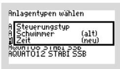
Mit dem Fenster „STEUERUNGSTYP“ können Sie zwischen einem zeit- oder einem schwimmergesteuerten Zyklus auswählen. In der zweiten Zeile „(NEU)“ kann der gewünschte Steuerungstyp eingestellt werden. Durch Betätigen der -Tasten wird zwischen „ZEIT“ oder „SCHWIMMER“ ausgewählt. Mit der -Taste wird der gewählte Steuerungstyp übernommen. Mit der Einstellung „ZEIT“ wird der Ablauf des Zyklus nur über die Zeit gesteuert, mit der Einstellung „SCHWIMMER“ ist er zusätzlich schwimmergesteuert.
