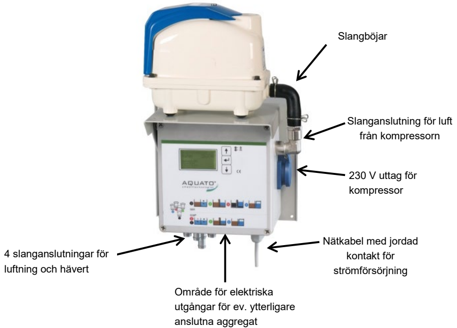
Figur 2: Anslutningar till styrning K-Pilot 18.1/18.3/18.4 med kompressor på konsol
