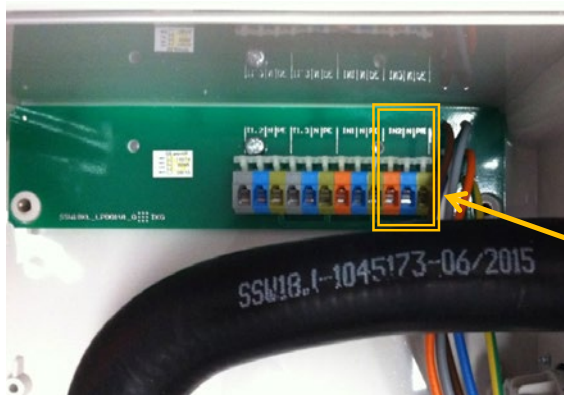
Figur 16: Anslutning av 2:a flottörställare som högvattenindikator vid K-Pilot 18.3
