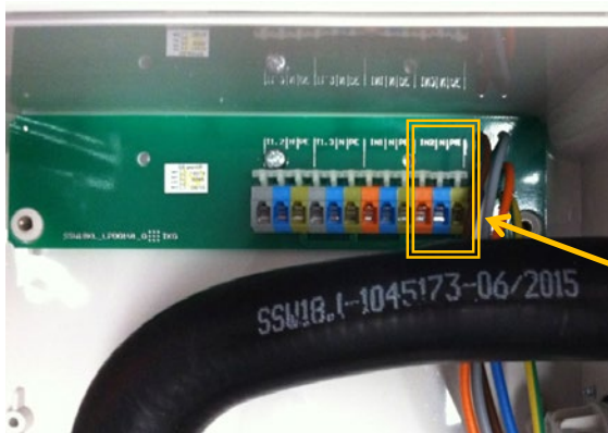
Figur 17: Anslutning flottörställare för buffert vid styrningstyp K-Pilot 18.3
