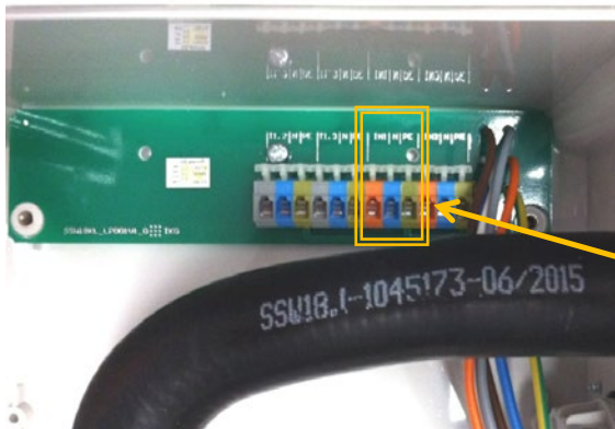
Figur 15: Anslutning standardflottörställare vid styrning K-Pilot 18.3/18.4
