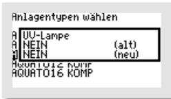
Benötigen Sie eine Hygienisierung, wählen Sie im Fenster „UV-LAMPE“ in der zweiten Zeile „(NEU)“ mit den -Tasten die Option „JA“ aus.
