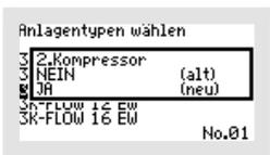
Wenn Sie eine Anlage mit 2 Verdichtern betreiben, wählen Sie bitte im Fenster mit der Abfrage „2.KOMPRESSOR“ in der unteren Zeile „(Neu)“ die Antwort „JA“ aus.
