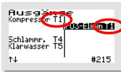
Jeder ausgewählten Funktion muss ein anderer Ausgang zugewiesen werden. Es darf **kein Ausgang mit 2 Funktionen** belegt werden!
