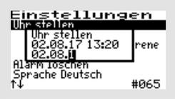
Die Uhr arbeitet quartzesteuert. Sie sollte bei der Wartung mit geprüft werden. Auf die richtige Einstellung der Uhr sollte geachtet werden, da die Auswertung der Wartung dadurch erleichtert wird.
