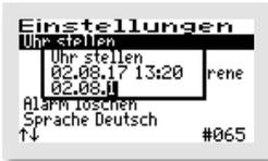
Die Uhr arbeitet quartzesteuert. Sie sollte bei der Wartung mit geprüft werden. Auf die richtige Einstellung der Uhr sollte geachtet werden, da die Auswertung der Wartung dadurch erleichtert wird.
