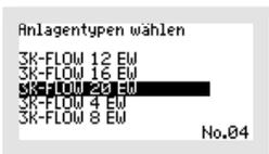
Für die Anlagengrößen von 21 bis 50 EW treffen Sie bitte die Auswahl „3K-FLOW ab 20“. Die Zyklus-Voreinstellungen für die Anlagengrößen von 21 bis 50 EW sind gleich, die unterschiedlichen benötigten Luftmengen werden durch unterschiedliche Größen und Mengen von Membranbelüftern und Verdichtern erreicht. Bei Bedarf können diese Einstellungen nachreguliert werden.
