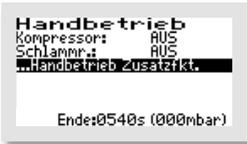
Zum zweiten Handbetrieb-Fenster (mit den Zusatzfunktionen) gelangt man über die letzte Zeile „...HANDBETRIEB ZUSATZFKT.“ In diesem Fenster werden die bei der Inbetriebnahme ausgewählten Zusatzfunktionen angezeigt.
