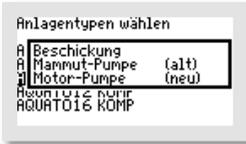
Wird für die Beschickung ein Druckluftheber genutzt, wählen Sie im Fenster „BESCHICKUNG“ bitte „MAMMUT-PUMPE“ mit den
