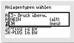
Schalten Sie die Überwachung im Menü "3~DRUCK ÜBERW." mit der Auswahl von "JA" ein, gibt es bei Ausfall des Gerätes eine Fehlermeldung. **Um diese Überwachung zu nutzen, muss der Drucksensor mit dem Luftschlauch zwischen dem Verdichter und den Belüftern verbunden sein.** Ist der Sensor nicht mit dem Luftschlauch verbunden, ist "NEIN" zu wählen.
