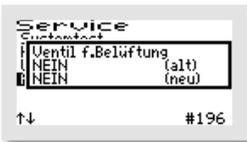
Nach Auswahl des Grundtyps wird im Fenster „VENTIL F. BELÜFTUNG“ abgefragt, ob die Belüftung mit einem Ventil angesteuert wird. Im Standardfall wird die Belüftung ohne Ventil angesteuert. Dazu bestätigen Sie die Auswahl „NEIN“ mit der Taste
