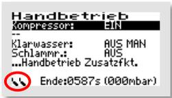
Links unten sind 2 Schwimmerschalter-Symbole mit der aktuellen Schwimmerstellung sichtbar.
