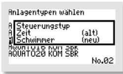
Für den Betrieb einer Anlage mit UV-Lampe oder Dosierung muss der Steuerungstyp „SCHWIMMER“ ausgewählt werden.
