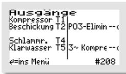
Wenn eine oder mehrere zusätzliche Funktionen – in diesem Beispiel die PO3-Elimination und der Dreiphasenkompessor – ausgewählt wurden, muss diesen Funktionen noch jeweils ein eigener Ausgang zugewiesen werden. Dies ist ersichtlich an den Leerzeichensymbolen "--" hinter den Aggregaten.
