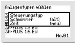
Mit dem Fenster „STEUERUNGSTYP“ können Sie zwischen einem zeit- oder einem schwimmergesteuerten Zyklus auswählen. In der zweiten Zeile „(NEU)“ kann der gewünschte Steuerungstyp eingestellt werden. Durch Betätigen der -Tasten wird zwischen „ZEIT“ oder „SCHWIMMER“ ausgewählt. Mit der -Taste wird der gewählte Steuerungstyp übernommen.
