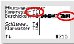
Jeder ausgewählten Funktion muss ein anderer Ausgang zugewiesen werden. Es darf **kein Ausgang mit 2 Funktionen** belegt werden!
