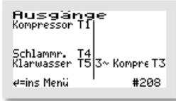
In diesem Beispiel wird der Verdichter über den Ausgang T1 gesteuert, der Schlammabzug über den Ausgang T4 und der Klarwasserabzug über den Ausgang T5. Dazu wird ein Dreiphasenkompressor über den Ausgang T3 angesteuert.
