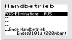
Je nach Voreinstellung können im 2. Handbetrieb-Fenster unterschiedliche Menüpunkte, wie z. B. „2. KOMPRESSOR“, „UV-LAMPE“, oder „PO3-Elimination“ ausgewählt werden, indem der schwarze Balken auf den gewünschten Eintrag gesetzt wird. Dann wird diese Funktion mit der -Taste „EIN“ und „AUS“ geschaltet.
