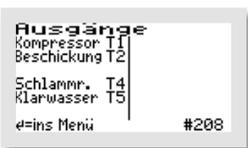
In diesem Beispiel wird der Verdichter über den Ausgang T1 gesteuert, die Beschickung über den Ausgang T2, der Schlammabzug über den Ausgang T4 und der Klarwasserabzug über den Ausgang T5.
