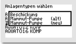
Wird die Beschickung mit einer Tauchmotorpumpe statt des Drucklufthebers ausgerüstet, treffen Sie bitte im Fenster „BESCHICKUNG“ die Auswahl „MOTOR-PUMPE“.
