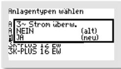
Schalten Sie die Überwachung im Menü „3~STROM ÜBERW.“ mit der Auswahl von „JA“ ein, gibt es bei Ausfall des Gerätes eine Fehlermeldung. **Für diese Überwachung muss die Steuerung allerdings ab Werk vorbereitet werden.** Wurde die Steuerung nicht vorbereitet, ist „NEIN“ zu wählen.
