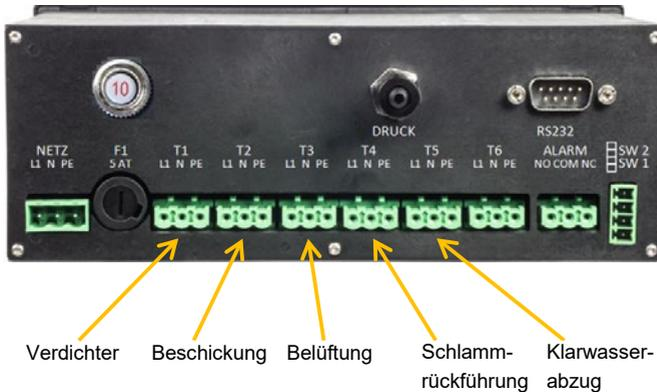
Abbildung 6: Standardbelegung der Steuerung K-Pilot 27.6
