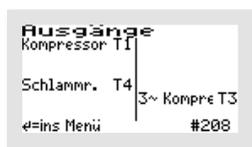
In diesem Beispiel wird der Verdichter über den Ausgang T1 gesteuert und der Schlammabzug über den Ausgang T4. Dazu wird ein Dreiphasenkompressor über den Ausgang T3 angesteuert.
