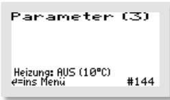
In diesem Beispiel ist eine Heizung mit einer Soll-Temperatur von 10 °C angeschlossen, die z. Zt. ausgeschaltet ist. Die Anzeige „AUS“ / „EIN“ hinter dem Wort Heizung zeigt den aktuellen Betriebszustand der Heizung an. Die Heizung springt bei einer Temperatur von 5 Grad unter dem Sollwert (hier: 10 - 5 = 5 °) an und läuft bis 2 Grad (hier: 10 + 2 = 12 °) über dem Sollwert erreicht sind.
