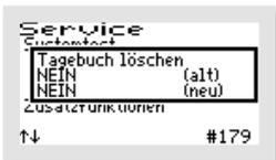
Als letztes Fenster in diesem Menü öffnet sich „TAGEBUCH LÖSCHEN“, hier werden bei der Auswahl von „JA“ alle Einträge und Einstellungen gelöscht. Danach startet die Steuerung wieder neu mit der Inbetriebnahme.
