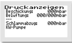
Ist statt des betreffenden Hebers eine Beschickungs-, Schlamm- und/oder Klarwasserpumpe angeschlossen, wird dies unterhalb der eigentlichen Druckanzeigen als Text angezeigt. Zudem wird dieser Ausgang nicht als Druckausgang angezeigt. Im Beispiel ist eine Klarwasserpumpe angeschlossen.
