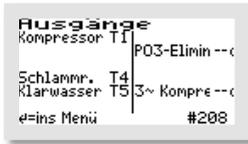
Wenn eine oder mehrere zusätzliche Funktionen – in diesem Beispiel die PO3-Elimination und der Dreiphasenkompressor – ausgewählt wurden, muss diesen Funktionen noch jeweils ein eigener Ausgang zugewiesen werden. Dies ist ersichtlich an den Leerzeichensymbolen „--“ hinter den Aggregaten.
