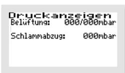
In diesem Menü wird der jeweilige Druck während des letzten Zyklus angezeigt. Belüftungs- und Überschussschlammgedruck werden jeweils bei den einzelnen Vorgängen gespeichert. Es wird immer nur die Druckmessung der jeweiligen letzten Phase angezeigt.
