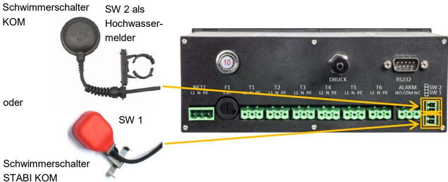
Abbildung 11: Anschluss 2. Schwimmerschalter als Hochwassermelder
