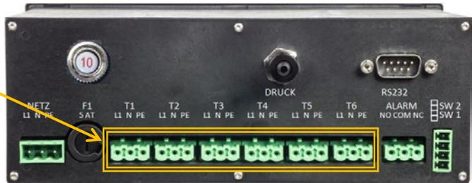
Abbildung 14: Anschluss Klarwasserpumpe
