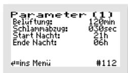
In diesem Menü wird die Dauer der Gesamtblüftungsphase und des Schlammabzugs angezeigt sowie der Beginn und das Ende des Nachtbetriebes.
