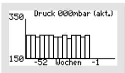
Im Grafik-Menü „DRUCK“ wird in der oberen Zeile der aktuelle Druck sowie in der Grafik wöchentlich der Gegendruck (aus der Drucküberwachung) dokumentiert.
