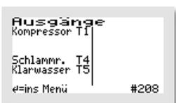
In diesem Beispiel wird der Verdichter über den Ausgang T1 gesteuert, der Schlammabzug über den Ausgang T4 und der Klarwasserabzug über den Ausgang T5.
