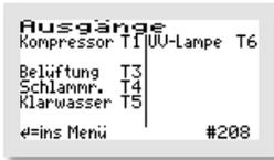
In diesem Beispiel wird der Verdichter über den Ausgang T1 gesteuert, die Belüftung über den Ausgang T3, der Schlammabzug über den Ausgang T4 und der Klarwasserabzug über den Ausgang T5. Dazu wird eine UV-Lampe über den Ausgang T6 angesteuert.
