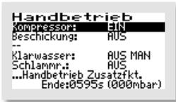
Das Menü Handbetrieb besteht aus 2 Fenstern. Mit den -Tasten kann zwischen den stets vorhandenen Parametern „KOMPRESSOR“ und „KLARWASSER“ sowie „SCHLAMMR“ (= Schlammrückführung) im ersten Fenster (mit den Standardfunktionen) ausgewählt werden, indem der schwarze Balken auf den gewünschten Eintrag gesetzt wird.
