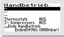
Je nach Voreinstellung können im 2. Handbetrieb-Fenster unterschiedliche Menüpunkte, wie z. B. „3-KOMPRESSOR“ oder „THERMOSTAT“, ausgewählt werden, indem der schwarze Balken auf den gewünschten Eintrag gesetzt wird. Dann wird diese Funktion mit der -Taste „EIN“ und „AUS“ geschaltet.
