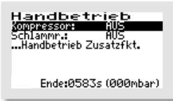
Mit den -Tasten kann zwischen den stets vorhandenen Parametern „KOMPRESSOR“ und „SCHLAMMR.“ (= Schlammrückführung) sowie weiteren – je nach Voreinstellung unterschiedlichen – Menüpunkten wie z. B. „2. KOMPRESSOR“ ausgewählt werden, indem der schwarze Balken auf den gewünschten Eintrag gesetzt wird.
