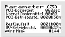
Im Beispiel sind eine Dosierpumpe zur Phosphatfällung und ein UV-Modul angeschlossen. In diesem Fall können die Angaben zum Dosiermittelvorrat und die Dosierzeit angepasst sowie die UV-Restlaufzeit zurückgesetzt werden.
