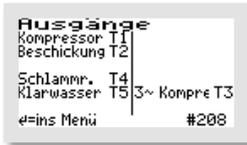
In diesem Beispiel wird der Verdichter über den Ausgang T1 gesteuert, die Beschickung über den Ausgang T2, der Schlammabzug über den Ausgang T4 und der Klarwasserabzug über den Ausgang T5. Dazu wird ein Dreiphasenkompessor über den Ausgang T3 angesteuert.
