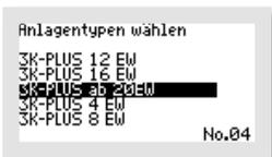
Für die Anlagengrößen von 21 bis 50 EW treffen Sie bitte die Auswahl „3K-PLUS ab 20“. Die Zyklus-Voreinstellungen für die Anlagengrößen von 21 bis 50 EW sind gleich, die unterschiedlichen benötigten Luftmengen werden durch unterschiedliche Größen und Mengen von Membranbelüftern und Verdichtern erreicht. Bei Bedarf können diese Einstellungen nachreguliert werden.
