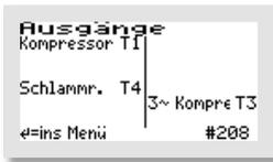
In diesem Beispiel wird der Verdichter über den Ausgang T1 gesteuert und der Schlammabzug über den Ausgang T4. Dazu wird ein Dreiphasenkompressor über den Ausgang T3 angesteuert.
