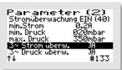
Ist ein Drehstrom-/Drei-Phasen-Verdichter ausgewählt, kann für diesen die Stromüberwachung separat „EIN“ oder „AUS“ geschaltet werden mit dem Menüpunkt „3~STROM ÜBERW.“.
