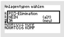
Um eine Phosphatfällung zu aktivieren, wählen Sie im Fenster „PO3-ELIMINATION“ in der zweiten Zeile „(NEU)“ die Option „JA“ mit den -Tasten aus.
