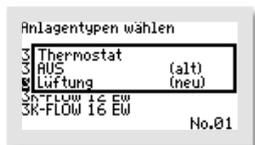
Zunächst können Sie im Fenster mit der Abfrage „THERMOSTAT“ die Regelung für einen Lüfter oder eine Heizung auswählen.
