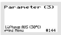
In diesem Beispiel ist ein Lüftungsventilator mit einer Soll-Temperatur von 30 °C angeschlossen, der z. Zt. ausgeschaltet ist. Die Anzeige „AUS“ / „EIN“ hinter dem Wort Lüftung zeigt den aktuellen Betriebszustand des Lüfters an.
