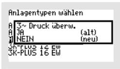
Anschließend werden Sie im Menü „3~DRUCK ÜBERW.“ gefragt, ob der 3-Phasen-Verdichter auf Druck überwacht werden soll.
