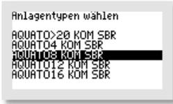
Danach wählen Sie als „ANLAGENTYP“ die gewünschte bzw. erforderliche EW-Zahl mit den -Tasten aus. Wenn die Markierung (= schwarzer Balken) auf der richtigen EW-Zahl (nach Klärtechnischer Berechnung) steht, bestätigen Sie mit der -Taste. Steht die erforderliche EW-Zahl nicht direkt zur Auswahl, wählen Sie den nächstgrößeren Eintrag.
