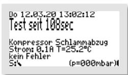
Der Test läuft vollautomatisch ab. Die einzelnen Funktionen werden nacheinander (jeweils ca. 15 Sekunden) geprüft. Funktioniert alles fehlerfrei, kommt keine Alarmmeldung. Der Testbetrieb kann durch Bedienen der
