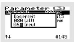
Mit der -Taste wird der Menüpunkt aufgerufen. Die Einstellungen werden mit den -Tasten geändert – hier von 80 auf 60 Sekunden – und mit der -Taste bestätigt.
