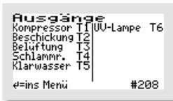
In diesem Beispiel wird der Verdichter über den Ausgang T1 gesteuert, die Beschickung über den Ausgang T2, die Belüftung über den Ausgang T3, der Schlammabzug über den Ausgang T4 und der Klarwasserabzug über den Ausgang T5. Dazu wird eine UV-Lampe über den Ausgang T6 angesteuert.
