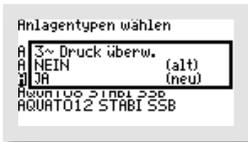
Schalten Sie die Überwachung im Menü "3~DRUCK ÜBERW." mit der Auswahl von "JA" ein, gibt es bei Ausfall des Gerätes eine Fehlermeldung. **Um diese Überwachung zu nutzen, muss der Drucksensor (Anschluss „PUMPE“) mit dem Luftschlauch zwischen dem Verdichter und den Belüftern verbunden sein.** Ist der Sensor (Anschluss „PUMPE“) nicht mit dem Luftschlauch verbunden, ist "NEIN" zu wählen.
