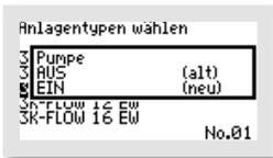
Benötigen Sie eine Pumpe zur Schlammrückführung, wählen Sie im nächsten Fenster „PUMPE“ in der zweiten Zeile „(NEU)“ mit den -Tasten die Option „EIN“ aus.
