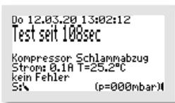
Der Test läuft vollautomatisch ab. Die einzelnen Funktionen werden nacheinander (jeweils ca. 15 Sekunden) geprüft. Funktioniert alles fehlerfrei, kommt keine Alarmmeldung. Der Testbetrieb kann durch Bedienen der
