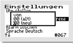
Der akustische Alarm ist standardmäßig von 17.00 Uhr bis 6.00 Uhr abgeschaltet. In dieser Zeit werden Fehler nur optisch angezeigt. Diese Einstellung kann im Menüpunkt „ALARM-PAUSE“ geändert werden.
