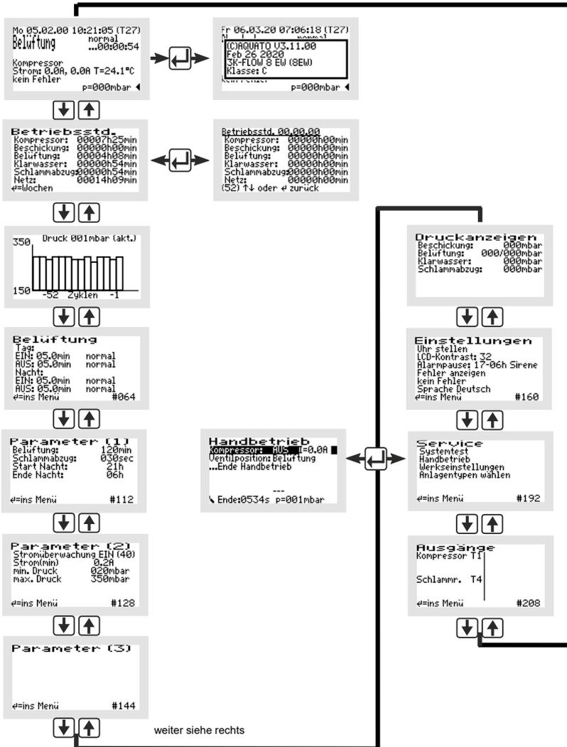
Abbildung 21: Menüstruktur Wirbelschwebbetanlage
