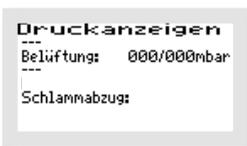
Ist statt des Hebers eine Schlammpumpe angeschlossen, wird dies unterhalb der eigentlichen Druckanzeigen als Text angezeigt. Zudem wird dieser Ausgang nicht als Druckausgang angezeigt.
