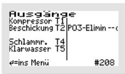
In diesem Beispiel ist als zusätzliche Funktion PO3-Elimination ausgewählt. Dieser Funktion muss noch ein freier Ausgang zugewiesen werden.
