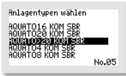
Alle Parameter für den Klärzyklus werden durch diese Auswahl automatisch voreingestellt, können aber bei Bedarf nachreguliert werden.
