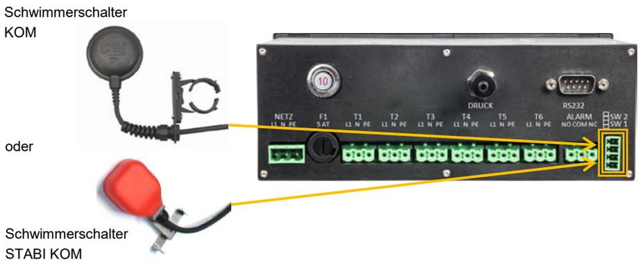
Abbildung 12: Anschluss Doppel-Schwimmerschalter
