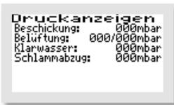
In diesem Menü wird der jeweilige Druck während des letzten Zyklus angezeigt. Beschickungs-, Klarwasser- und Überschuss-schlammgegendruck werden jeweils bei den einzelnen Vorgängen gespeichert. Es wird immer nur die Druckmessung der jeweiligen letzten Phase angezeigt. Für die Belüftung werden 2 jeweils Werte angezeigt, der minimale und der maximale Druck. Ist die Drucküberwachung ausgeschaltet, entfällt dieses Menü.
