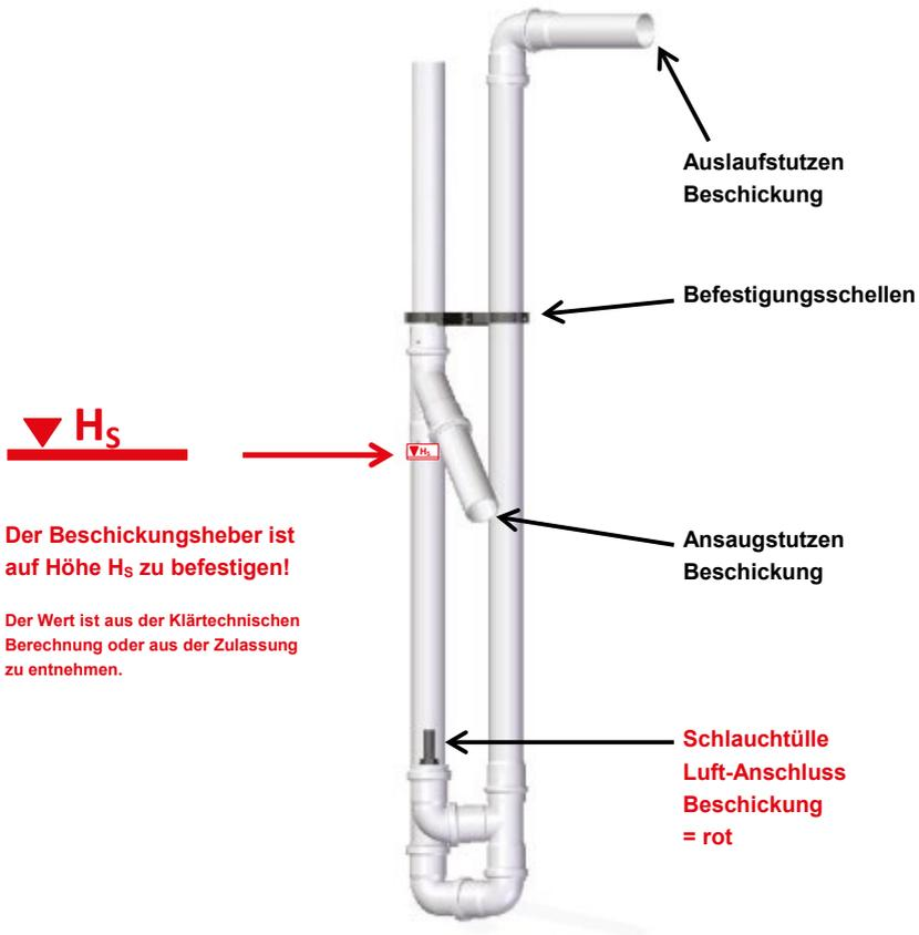
**Der Beschickungsheber ist auf Höhe  $H_s$  zu befestigen!**
