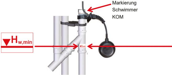
Abbildung 16: Befestigung Schwimmerschalter
