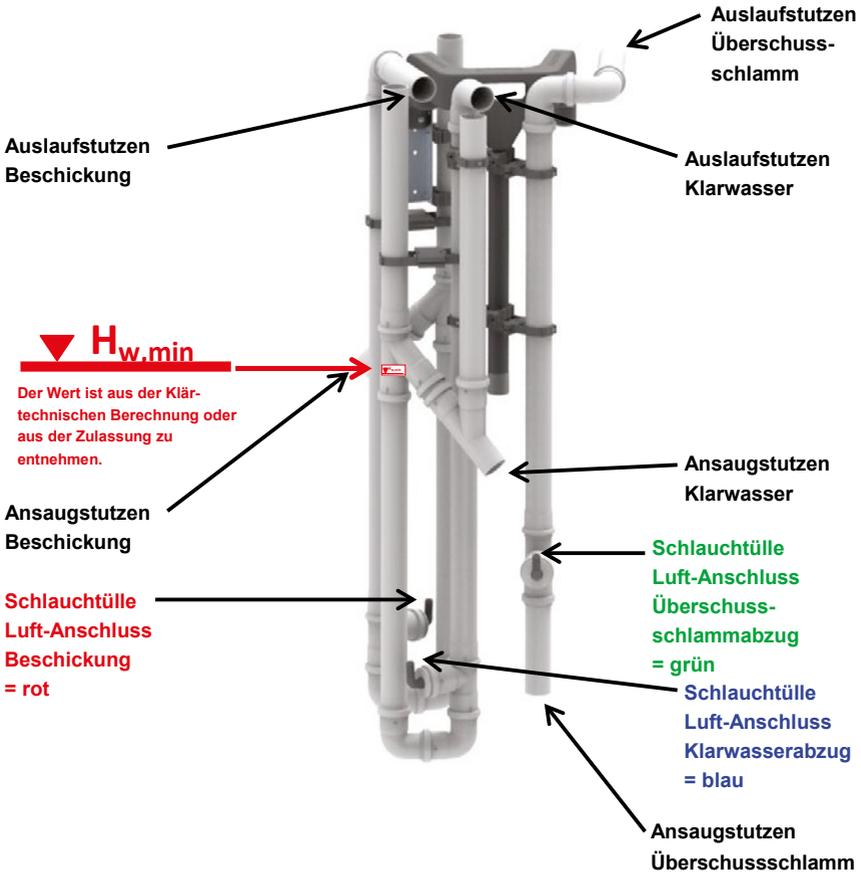
Abbildung 11: Beschickungs-, Klarwasser- und Überschussschlammheber als Einheit
