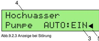
Abb.9.2.3 Anzeige bei Störung
