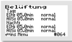
Im Menü „BELÜFTUNG“ werden die ausgewählten Belüftungsintervalle im Tag- und im Nachtbetrieb angezeigt, d. h. es wird angezeigt für wie viele Minuten die Belüftung jeweils im Wechsel „EIN“ bzw. „AUS“ geschaltet wird (Taktung).
