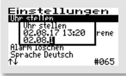
Die Uhr arbeitet quartzgesteuert. Sie sollte bei der Wartung mit geprüft werden. Auf die richtige Einstellung der Uhr sollte geachtet werden, da die Auswertung der Wartung dadurch erleichtert wird.
