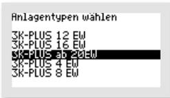
Für die Anlagengrößen von 21 bis 50 EW treffen Sie bitte die Auswahl „3K-FLOW ab 20“ bzw. „3K-PLUS ab 20“. Die Zyklus-Voreinstellungen für die Anlagengrößen von 21 bis 50 EW sind gleich, die unterschiedlichen benötigten Luftmengen werden durch unterschiedliche Größen und Mengen von Membranbelüftern und Verdichtern erreicht. Bei Bedarf können diese Einstellungen nachreguliert werden.
