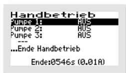
Mit den -Tasten kann zwischen den vorhandenen Parametern „PUMPE 1“ bis „PUMPE 4“ – die angezeigten Pumpen sind je nach Voreinstellung unterschiedlich – ausgewählt werden, indem der schwarze Balken auf den gewünschten Eintrag gesetzt wird.
