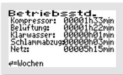
Im Kapitel BETRIEBSSTUNDEN Ihrer Steuerung werden die Betriebsstunden der jeweiligen Aggregate angezeigt. Die Betriebsstunden werden hochgezählt, wenn die Steuerung den Kompressor (bzw. eventuell die Pumpe) eingeschaltet hat. Die Anzeige erfolgt in Stunden und Minuten.
