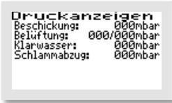
Das Menü „DRUCKANZEIGEN“ ist nur sichtbar, wenn bei der Inbetriebnahme die Drucküberwachung ausgewählt wurde. In diesem Menü wird der jeweilige Druck während des letzten Zyklus angezeigt. Beschickungs-, Klarwasser- und Überschussschlammgegen- druck werden jeweils bei den einzelnen Vorgängen gespeichert. Es wird immer nur die Druckmessung der jeweiligen letzten Phase angezeigt.
