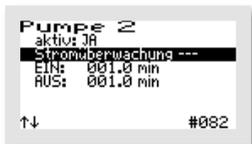
Bei der „STROMÜBERWACHUNG“ gibt es 3 Optionen. Sie ist standardmäßig auf „KONT.“ (= kontinuierlich) voreingestellt, kann jedoch auch auf „ZYKLISCH“ eingestellt oder ganz abgeschaltet werden (Anzeige: „---“). Wurde die Option „ZYKLISCH“ gewählt, kann der Zeitraum im Menü „PARAMETER (2)“ eingestellt werden (vgl. dazu Kapitel 11.3.4.3).
