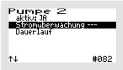
Bei der „STROMÜBERWACHUNG“ gibt es 3 Optionen. Sie ist standardmäßig auf „KONT.“ (= kontinuierlich) voreingestellt, kann jedoch auch auf „ZYKLISCH“ eingestellt oder ganz abgeschaltet werden (Anzeige: „---“). Wurde die Option „ZYKLISCH“ gewählt, kann der Zeitraum im Menü „PARAMETER (2)“ eingestellt werden (vgl. dazu Kapitel 12.3.4.3).
