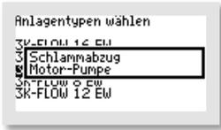
Danach erfolgt die Abfrage, wie der Schlammabzug stattfinden soll, mit einer Tauchmotorpumpe oder mit einem Druckluftheber. Soll die Schlammrückführung mit einer Pumpe statt eines Hebers durchgeführt werden, wählen Sie bitte im darauffolgenden Fenster „SCHLAMMABZUG“ mit den -Tasten die Option „MOTOR-PUMPE“ aus.
