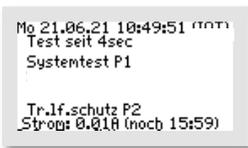
Der Test läuft vollautomatisch ab. Die einzelnen Funktionen werden nacheinander (jeweils ca. 15 Sekunden) geprüft. Arbeiten alle Aggregate fehlerfrei, kommt keine Alarmmeldung. Der Testbetrieb kann durch Bedienen der
