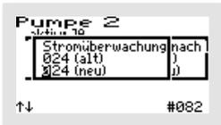
Zusätzlich wird in der Hauptanzeige zur Überwachung der aktuell fließende Strom angezeigt.
