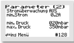
In diesem Menü kann die Stromüberwachung „AUS“ oder „EIN“ geschaltet werden. Im Standardfall ist die Stromüberwachung auf „EIN“ gestellt.
