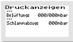
Das Menü „DRUCKANZEIGEN“ ist nur sichtbar, wenn bei der Inbetriebnahme die Drucküberwachung ausgewählt wurde. In diesem Menü wird der jeweilige Druck während des letzten Zyklus angezeigt. Belüftungs- und Überschussschlammgegendruck werden jeweils bei den einzelnen Vorgängen gespeichert. Es wird immer nur die Druckmessung der jeweiligen letzten Phase angezeigt.
