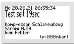
Der Test läuft vollautomatisch ab. Die einzelnen Funktionen werden nacheinander (jeweils ca. 15 Sekunden) geprüft. Arbeiten alle Aggregate fehlerfrei, kommt keine Alarmmeldung. Der Testbetrieb kann durch Bedienen der
