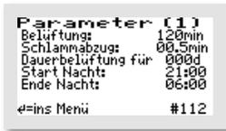
In diesem Menü wird die Dauer der Gesamtblüftungsphase und des Schlammabzugs angezeigt, der Beginn und das Ende des Nachtbetriebes sowie je nach Einstellung weitere Parameter.
