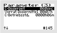
Mit der (mittleren) -Taste kommen Sie ins Menü. Die Zeile „C-DOSIERZEIT“ wird mit den -Tasten ausgewählt.
