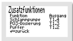
In diesem Beispiel der Anzeige der „ZUSATZFUNKTIONEN“ ist die gewählte Einstellung „SCHLAMPpumpe“ auf dem Ausgang „T1.4“ und „PO3-DOSIERUNG“ zur Fällmitteldosierung für die Phosphatfällung auf „T1.3“ sowie „PUFFER“ auf „T1.2“ für die Pufferpumpe.
