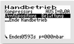
Ist die „VENTILPOSITION“ ausgewählt, wird mit der -Taste das Fenster zur Einstellung der Ventilposition für die – je nach Voreinstellung – unterschiedlichen möglichen Betriebszustände („SCHLAMM“, „PUFFER“, „BELÜFTUNG“, „BELÜFTUNG 1.K.“, „KLARWASSER“) geöffnet.
