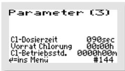
Im Menü Parameter 3 werden die „CL-DOSIERZEIT“ pro Zyklus, der „VORRAT CHLORUNG“ und die Gesamtlaufzeit der Dosierpumpe als „CL-BETRIEBSSTD.“ angezeigt. Hier können auch die Einstellungen von „CL-DOSIERZEIT“ pro Zyklus und „VORRAT CHLORUNG“ geändert werden.
