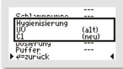
Nur wenn, wie im Beispiel, bei der Funktion „HYGIENISIERUNG“ „CL“ ausgewählt wurde, folgt danach noch die Abfrage, wie lange das Desinfektionsmittel bei jedem Zyklus während des Klarwasserabzuges zudosiert werden soll.
