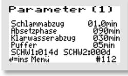
Im Beispiel wird die Schwimmermeldung für den Schwimmer 1 nach 14 Tagen ohne Schaltvorgang des Schwimmers aktiv. Die Meldung für Schwimmerschalter 2 ist ausgeschaltet.
