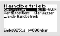
Ist der „KOMPRESSOR“ ausgewählt, kann er mit der -Taste „EIN“ und „AUS“ geschaltet werden.
