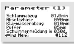
Im Menü „Parameter 1“ wird bei Eingabe von Passwort 2 in der untersten Zeile der/die angeschlossenen Schwimmerschalter mit der eingestellten Wartezeit bis zur Warnung angezeigt.
