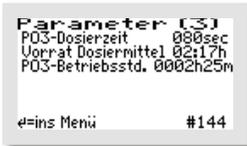
Im Menü Parameter 3 werden die „PO3-DOSIERZEIT“ pro Zyklus, der „VORRAT DOSIERMITTEL“ und die Gesamtlaufzeit der Dosierpumpe als „PO3-BETRIEBSSTD.“ angezeigt. Hier können auch die Einstellungen von „PO3-DOSIERZEIT“ pro Zyklus und „VORRAT DOSIERMITTEL“ geändert werden.
