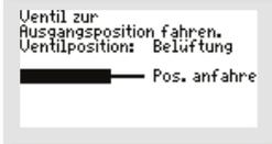
Das Ventil wird in die Ausgangsposition zurück gefahren.
