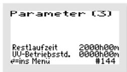
Im Menü Parameter 3 werden die „RESTLAUFZEIT“ der UV-Lampe und die Gesamtlaufzeit der UV-Leuchte als „UV-BETRIBSSTD.“ angezeigt. Hier wird die Einstellungen von „RESTLAUFZEIT“ nach dem Leuchtenwechsel wieder auf 2000 Stunden eingestellt.
