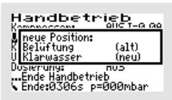
Mit den -Tasten wird die gewünschte Ventilposition ausgewählt und nach Betätigen der -Taste wird diese Position angefahren. Ist dabei der Kompressor auf „EIN“ geschaltet, kann die Funktion zusätzlich auch im Behälter überprüft werden.
