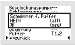
Nach dem Beenden des Menüs kommt in diesem Fall noch die Abfrage, ob die Pufferentleerung mit einem Schwimmerschalter gesteuert werden soll: „SCHWIMMER F. PUFFER“. Soll der Puffer schwimmergesteuert entleert werden, wählen Sie „JA“. Diese Option darf **nur** bei der Steuerung **K-Pilot 18.3** gewählt werden. Soll der Puffer rein zeitgesteuert entleert werden, wählen Sie „NEIN“.
