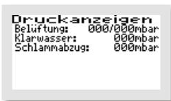
In diesem Menü wird der jeweilige Druck während des letzten Zyklus angezeigt. Der Klarwasser- und der Überschussschlammgedruck werden jeweils bei den einzelnen Vorgängen gespeichert. Es wird immer nur die Druckmessung der jeweiligen letzten Phase angezeigt.
