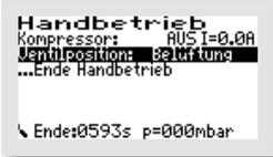
Ist die „VENTILPOSITION“ ausgewählt, wird mit der -Taste das Fenster zur Einstellung der Ventilposition für die – je nach Voreinstellung – unterschiedlichen möglichen Betriebszustände („SCHLAMM“, „PUFFER“, „BELÜFTUNG“, „BELÜFTUNG 1.K.“, „KLARWASSER“) geöffnet.
