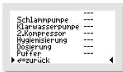
Beendet wird die Auswahl und Zuordnung der Zusatzfunktionen durch Auswahl der untersten Zeile ▶ „ZURÜCK“ ◀ mit den Tasten und daran anschließendes Bestätigen mit der Taste.
