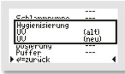
Bei Auswahl von „UV“ erfolgt die Hygienisierung mittels UV-Lampe stets während des Klarwasserabzuges.
