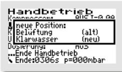
Mit den -Tasten wird die gewünschte Ventilposition ausgewählt und nach Betätigen der -Taste wird diese Position angefahren. Ist dabei der Kompressor auf „EIN“ geschaltet, kann die Funktion zusätzlich auch im Behälter überprüft werden.
