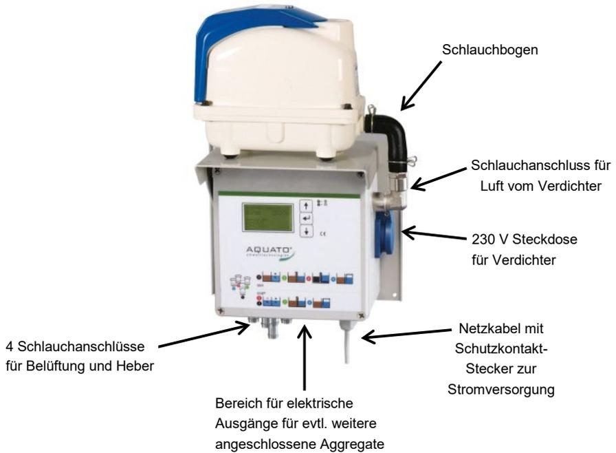
**Abbildung 2:** Anschlüsse an der Steuerung K-Pilot 18.1/18.3/18.4 mit Verdichter auf Konsole
