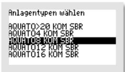
Danach wählen Sie als „ANLAGENTYP“ die gewünschte bzw. erforderliche EW-Zahl mit den -Tasten aus. Wenn die Markierung (= schwarzer Balken) auf der richtigen EW-Zahl (nach Klärtechnischer Berechnung) steht, bestätigen Sie mit der -Taste. Steht die erforderliche EW-Zahl nicht direkt zur Auswahl, wählen Sie den nächstgrößeren Eintrag.
