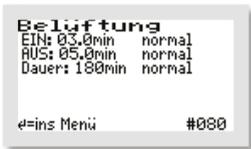
Im Menü „BELÜFTUNG“ werden die ausgewählten Belüftungsintervalle im Normalbetrieb angezeigt, d. h. für wie viele Minuten die Belüftung jeweils im Wechsel „EIN“ bzw. „AUS“ geschaltet wird (Taktung).
