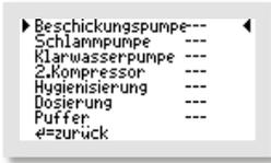
Um ein Aggregat aktivieren zu können, muss die Zeile mit der gewünschten/erforderlichen Zusatzfunktion mit den Tasten ausgewählt werden. Danach wird mit der -Taste, der elektrische Ausgang ausgewählt, der genutzt werden soll. Bei jedem Tastendruck der -Taste wechselt die Anzeige in der markierten Zeile. Von „- -“ wechselt sie auf die Ausgänge von T1.2 über T1.3 zu T1.4 und wieder zurück zu „- -“.
