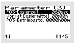
Mit der (mittleren) -Taste kommen Sie ins Menü. Die Zeile „PO3-DOSIERZEIT“ wird mit den -Tasten ausgewählt.
