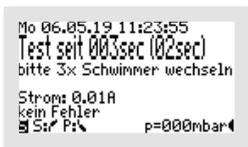
Ist der STEUERUNGSTYP „SCHWIMMER“ eingestellt, muss zu Beginn des Systemtests 3 mal der Schwimmerschalter auf und ab bewegt werden, um die Funktion des Schwimmerschalters zu überprüfen. Danach läuft der Test vollautomatisch ab. Bei STEUERUNGSTYP „ZEIT“ entfällt die Schwimmerprüfung, es beginnt direkt der vollautomatische Testbetrieb.
