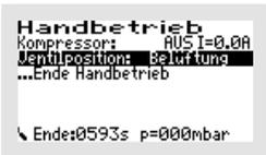
Ist die „VENTILPOSITION“ ausgewählt, wird mit der -Taste das Fenster zur Einstellung der Ventilposition für die – je nach Voreinstellung – unterschiedlichen möglichen Betriebszustände („SCHLAMM“, „PUFFER“, „BELÜFTUNG“, „BESCHICKUNG“, „KLARWASSER“) geöffnet.
