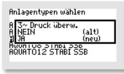
Schalten Sie die Überwachung im Menü "3~DRUCK ÜBERW." mit der Auswahl von "JA" ein, gibt es bei Ausfall des Gerätes eine Fehlermeldung. **Um diese Überwachung zu nutzen, muss der Drucksensor mit dem Luftschlauch zwischen dem Verdichter und den Belüftern verbunden sein.** Ist der Sensor nicht mit dem Luftschlauch verbunden, ist "NEIN" zu wählen.
