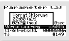
Dabei wird nicht direkt die gespeicherte Menge des Dosiermittels eingegeben, sondern die Dosierpumpengesamtlaufzeit, für die der Vorrat reicht.
