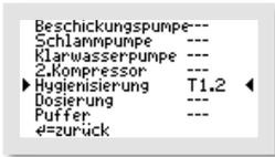
Wurde, wie im Beispiel, die Funktion „HYGIENISIERUNG“ auf den Ausgang „T1.2“ gelegt, muss auch der elektrische Anschluss der Hygienisierung (hier mit Desinfektionsmitteldosierung) auf diesen Kontakt gelegt werden.
