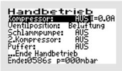
Mit den -Tasten kann zwischen den stets vorhandenen Parametern „KOMPRESSOR“ und „VENTILPOSITION“ sowie weiteren – je nach Voreinstellung unterschiedlichen – Menüpunkten wie z. B. „BESCHICKUNGSPUMPE“, „SCHLAMMPUMPE“, „KLARWASSERPUMPE“, „2. KOMPRESSOR“, „UV-LAMPE“, „DOSIERUNG“ oder „PUFFER“ ausgewählt werden, indem der schwarze Balken auf den gewünschten Eintrag gesetzt wird.
