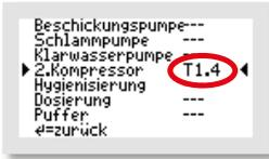
Der Ausgang „T1.4“ darf bei der Steuerung **K-Pilot 18.3** **nicht** belegt werden, da er physisch nicht zur Verfügung steht! Wird diesem Ausgang eine Funktion zugewiesen, kann sie nicht ausgeführt werden. **Nur** bei der Steuerung **K-Pilot 18.4** steht der Ausgang „T1.4“ zur Verfügung.
