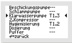
Wurde, wie im Beispiel, die Funktion „**HYGIENISIERUNG**“ auf den Ausgang „T1.2“ gelegt, muss auch der elektrische Anschluss der Hygienisierung (UV-Lampe oder Desinfektionsmitteldosierung) auf diesen Kontakt gelegt werden.
