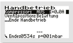
Ist der Kompressor ausgewählt, kann er mit der -Taste „EIN“ bzw. „AUS“ geschaltet werden.
