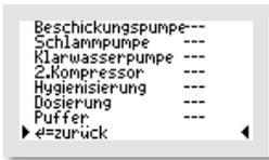
Beendet wird dieses Menü, indem die Markierung ► ◀ in die letzte Zeile auf „ZURÜCK“ gesetzt und dann die -Taste betätigt wird.
