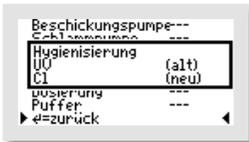
Nach dem Beenden des Menüs kommt in diesem Fall noch die Abfrage, welche „HYGIENISIERUNG“ gewünscht ist. Zum Betrieb mit Dosierung eines Desinfektionsmittels (z. B. Chlor) wählen Sie „CL“.
