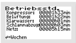
Im Menü „BETRIEBSSTUNDEN“ werden die Betriebsstunden der jeweiligen Aggregate angezeigt. Die Betriebsstunden werden hochgezählt, wenn die Steuerung den Kompressor (bzw. bei Steuerung K-Pilot 18.3/18.4 eventuell eine Pumpe) eingeschaltet hat. Die Anzeige erfolgt in Stunden und Minuten.
