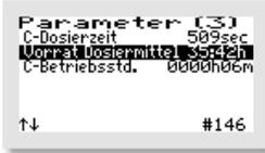
Im Beispiel ist ein Dosiermittelvorrat mit einer Gesamtlaufzeit der Dosierpumpe von 35 Stunden und 42 Minuten eingestellt.
