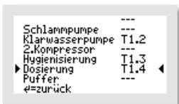
Bei der Steuerung **K-Pilot 18.4** stehen die Ausgänge „T1.2“, „T1.3“ und „T1.4“ zur Verfügung. Es können also maximal 3 Zusatzfunktionen ausgewählt werden, wie hier beispielsweise Klarwasserpumpe, Hygienisierung und Dosierung.
