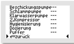
Beendet wird die Auswahl und Zuordnung der Zusatzfunktionen durch Auswahl der untersten Zeile ▶ „ZURÜCK“ ◀ mit den Tasten und daran anschließendes Bestätigen mit der -Taste.
