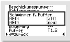
Bei der Steuerung **K-Pilot 18.4** muss die Option „**NEIN**“ gewählt werden, da kein Anschluss für den Pufferschwimmer vorhanden ist. Der Puffer kann nur rein zeitgesteuert entleert werden.
