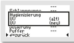
Bei Auswahl von „UV“ erfolgt die Hygienisierung mittels UV-Lampe stets während des Klarwasserabzuges.
