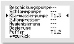
Bei der Steuerung **K-Pilot 18.3** stehen die Ausgänge „**T1.2**“ und „**T1.3**“ zur Verfügung. Es können also maximal 2 Zusatzfunktionen ausgewählt werden, wie hier im Beispiel Puffer- und Klarwasserpumpe.
