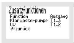
Hier als Beispiel die Anzeige der „ZUSATZFUNKTIONEN“ mit der gewählten Einstellung „Klarwasserpumpe“ auf dem Ausgang „T1.3“ und „UV“ für die UV-Lampe „T1.2“.
