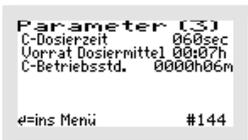
Im Menü Parameter 3 werden die „C-DOSIERZEIT“ pro Dosierung, der „VORRAT DOSIERMITTEL“ und die Gesamtlaufzeit der Dosierpumpe als „C-BETRIEBSSTD.“ angezeigt. Hier können auch die Einstellungen von „C-DOSIERZEIT“ pro Dosierung und „VORRAT DOSIERMITTEL“ geändert werden.
