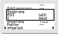
Nur wenn, wie im Beispiel, bei der Funktion „DOSIERUNG“ eine „C“-Quelle gewählt wurde, folgt danach noch die Abfrage, wie häufig die C-Quelle zudosiert werden soll. Die Dosierung der „C“-Quelle erfolgt ausschließlich im Sparbetrieb, wenn der Biologie keine anderen Nährstoffe zugeführt werden.
