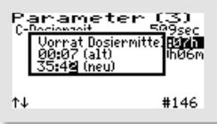
Dabei wird nicht direkt die gespeicherte Menge des Dosiermittels eingegeben, sondern die Dosierpumpengesamtlaufzeit, für die der Vorrat reicht.
