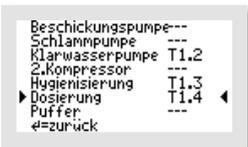
Bei der Steuerung **K-Pilot 18.4** stehen die Ausgänge „**T1.2**“, „**T1.3**“ und „**T1.4**“ zur Verfügung. Es können also maximal 3 Zusatzfunktionen ausgewählt werden, wie hier im Beispiel Klarwasserpumpe, Hygienisierung und Dosierung.
