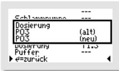
Bei Auswahl von „PO3“ wird das Fällmittel im Normalbetrieb jeweils einmal pro Zyklus zudosiert. Im Sparbetrieb entfällt die Dosierung, da der Anlage in dieser Zeit kein neues Phosphat zugeführt wird.
