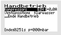
Nach Erreichen der Position wird bei eingeschaltetem Verdichter auch die Funktion, hier zum Beispiel der Klarwasserabzug, wie im Automatikbetrieb ausgeführt und kann zusätzlich auch im Behälter überprüft werden.
