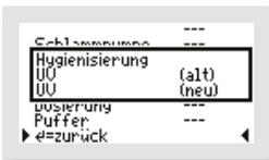
Nach dem Beenden des Menüs kommt in diesem Fall noch die Abfrage, welche „**HYGIENISIERUNG**“ gewünscht ist. Soll eine UV-Lampe betrieben werden, wählen Sie „**UV**“.
