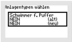
Mit der Steuerung **K-Pilot 18.1/18.4** kann der Puffer **nur** rein **zeitgesteuert** ohne Schwimmerschalter betrieben werden, deshalb muss bei der Abfrage „Schwimmer f. Puffer“ „NEIN“ ausgewählt werden.
