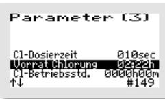
Im Beispiel ist ein Dosiermittelvorrat (= „VORRAT CHLORUNG“) mit einer Gesamtlaufzeit der Dosierpumpe von 2 Stunden und 22 Minuten eingestellt.
