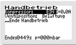
Im Handbetrieb kann der KOMPRESSOR manuell „EIN“ oder „AUS“ geschaltet sowie jede verfügbare VENTILPOSITION angefahren werden (z. B. für einen Testlauf).
