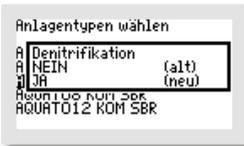
Ist eine „DENITRIFIKATION“ gewünscht/erforderlich, kann diese im nächsten Fenster zugeschaltet werden. In der zweiten Zeile „(NEU)“ kann die gewünschte Option ausgewählt werden. Die Auswahl zwischen „JA“ oder „NEIN“ erfolgt mit den -Tasten. Mit der -Taste wird der gewählte Zustand übernommen. „JA“ bedeutet, die Anlage läuft mit Denitrifikationsphase, bei „NEIN“ ist diese Phase abgeschaltet.
