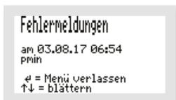
Das Fehlerlogbuch zeigt die letzten 30 Fehlerereignisse mit Datum und Uhrzeit an. Mit den -Tasten wird im Logbuch geblättert, mit der -Taste wird das Menü verlassen.
