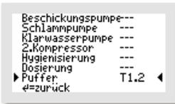
Wurde, wie im Beispiel, zum Betrieb eines Puffers mit Pufferpumpe die Funktion „PUFFER“ auf den Ausgang „T1.2“ gelegt, muss auch der elektrische Anschluss der Pufferpumpe auf diesen Kontakt gelegt werden.
