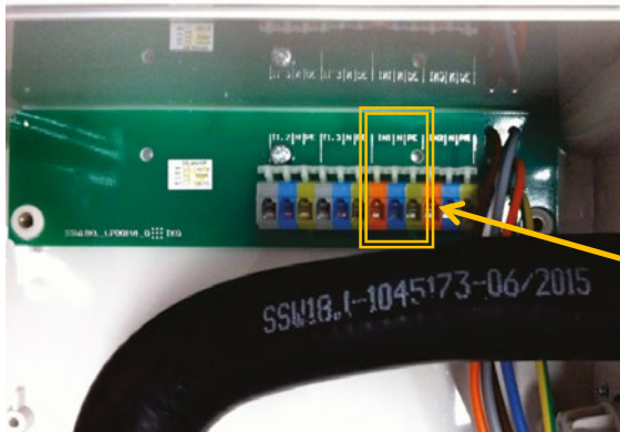
Abbildung 23: Anschluss Schwimmer für Klarwasserpumpe in Steuerung K-Pilot 18.3/18.4
