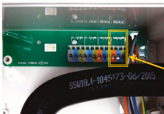
Abbildung 18: Anschluss 2. Schwimmerschalter als Hochwassermelder bei K-Pilot 18.3
