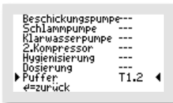
Abbildung 30: Pufferpumpe und Schwimmerschalter für Puffer an Steuerung K-Pilot 18.3
