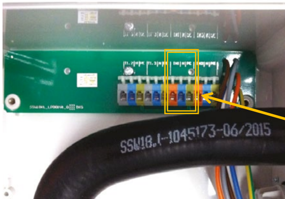
Abbildung 17: Anschluss Standardschwimmerschalter bei Steuerung K-Pilot 18.3/18.4
