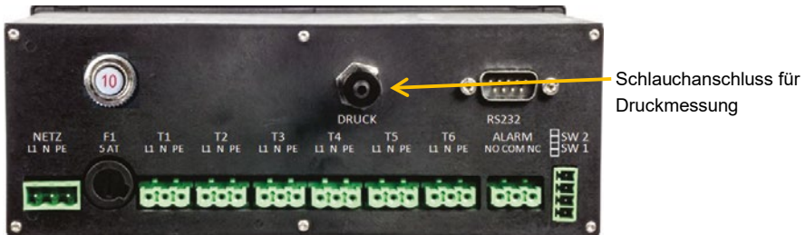
Abbildung 4: Anschluss für Druckmessung an der Steuerung
